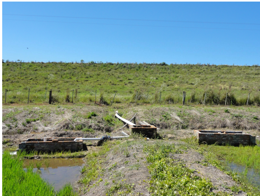
Figura 20 - Sistema Comparativo – Hidrômetro x Vertedor
