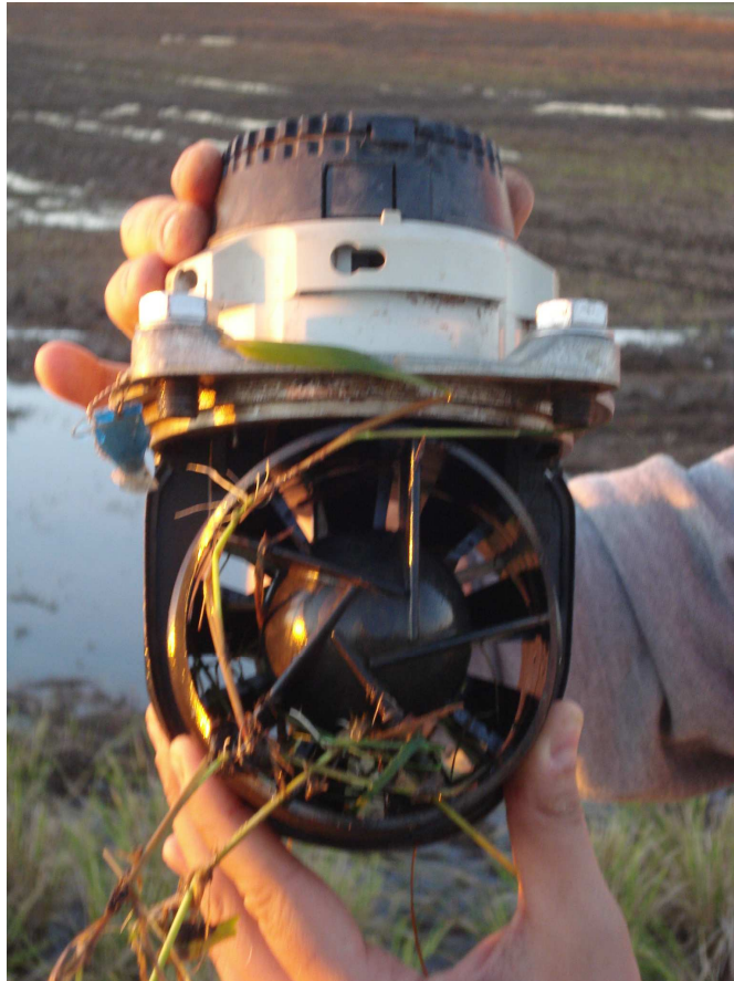
Figura 31 - Sujeira no Hidrômetro (1).
