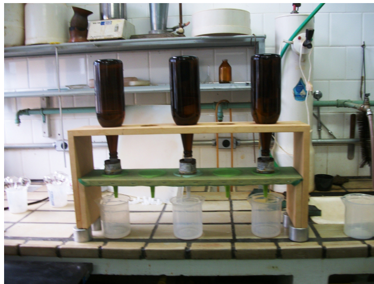
Figura 25: Imagem do permeâmetro adaptado, com estruturas de madeira e garrafas de vidro como reservatórios de água, notar a presença das amostras indeformadas e de béquer como recipiente coletor da água percolada.
