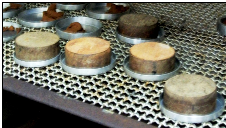
Figura 24: Amostras do material coletado em campo, onde foram conservadas suas características estruturais (amostras não deformadas), necessárias para os ensaios de condutividade hidráulica e de porosidade total.
