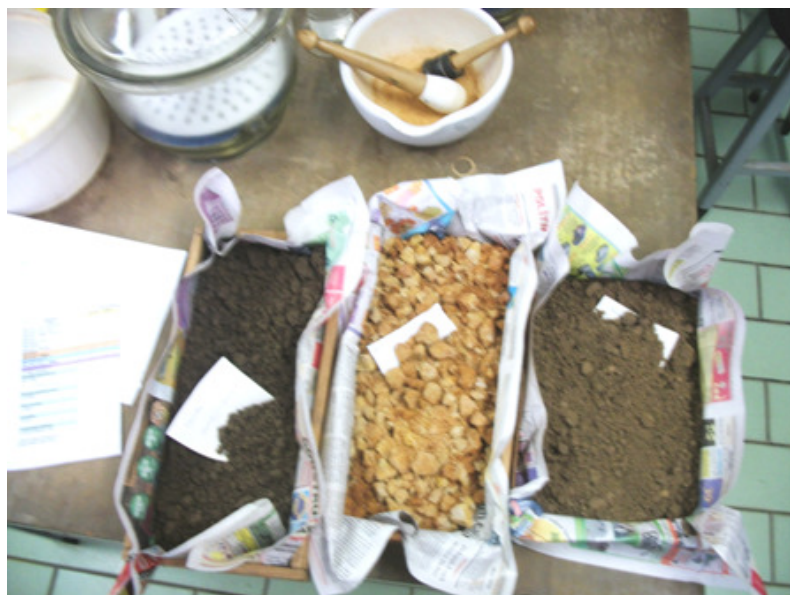
Figura 22: Ilustra as três amostras deformadas coletadas nas áreas de estudo e ao fundo o recipiente para destorroamento do material (solo e/ou rocha) com dois destorroadores e o dessecador.
