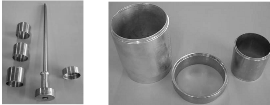
Figura 23 a e b: Ilustra diferentes tamanhos de cilindros que podem ser utilizados para coleta de amostras indeformadas de solo.
