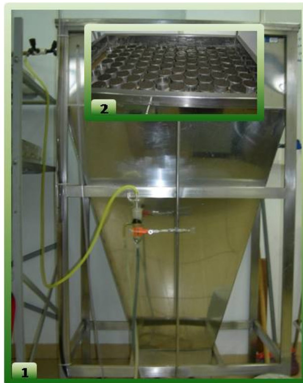
Figura 21: Equipamento que determina a porosidade, denominado como método da coluna de areia.
