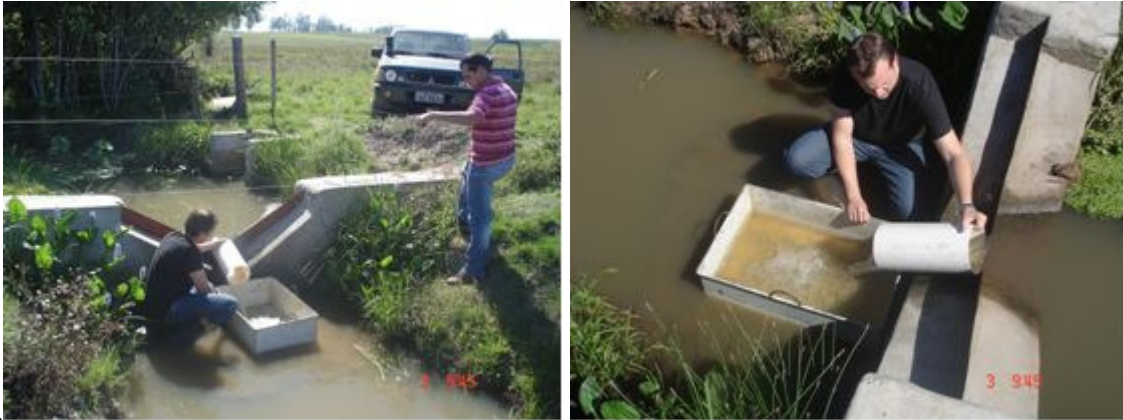
Figura 4.7 - Demonstração da medição volumétrica de vazão.
