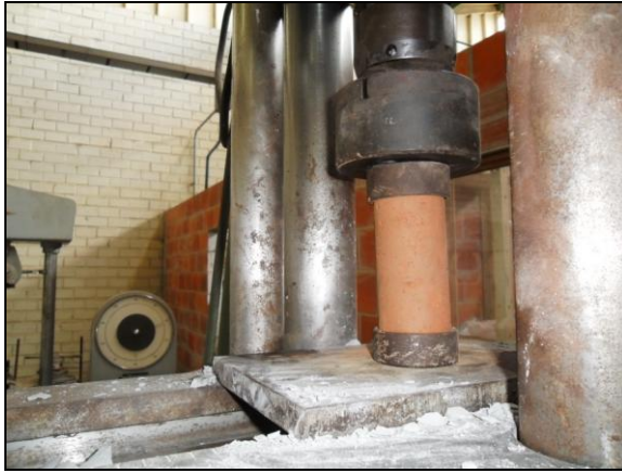
Figura 3.3 – Ruptura do corpo de prova cilíndrico
