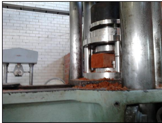
Figura 3.5 – Ruptura do corpo de prova prismático
