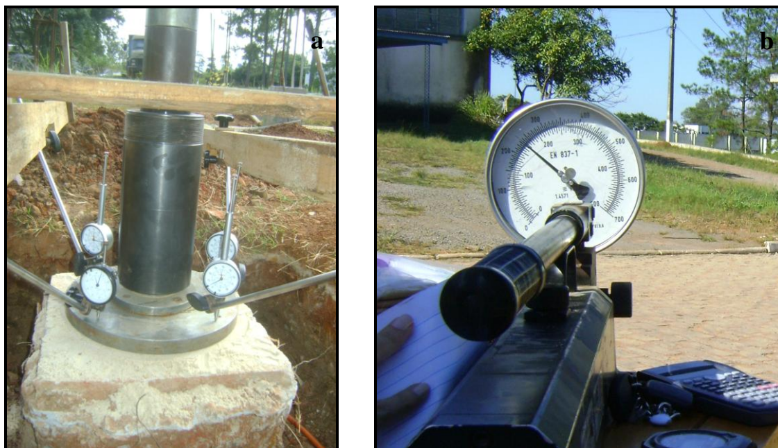
Figura 3.9 – (a) Macaco hidráulico, placa, deflectômetros e (b) manômetro
