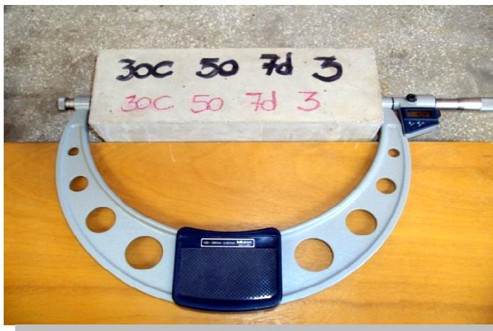
Figura 4.9 - Equipamento utilizado no ensaio de retração total - comparador de expansibilidade
