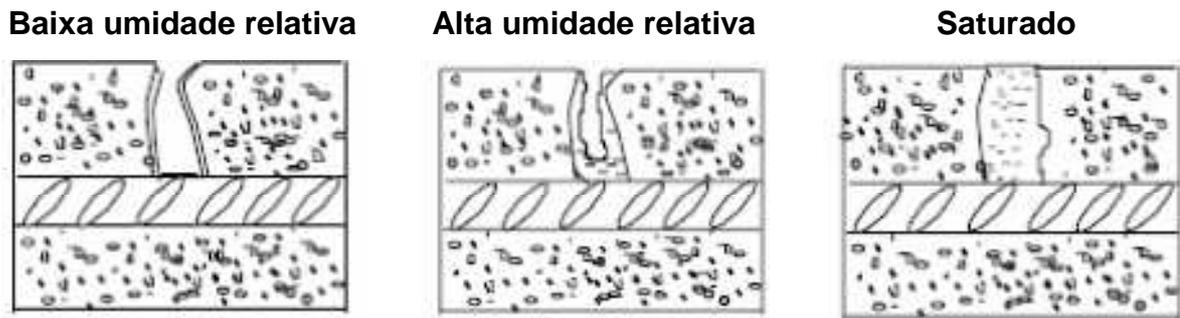
**Figura 3.20 - Representação esquemática do teor de umidade dos poros de concreto em função da umidade relativa - adaptado (ANDRADE, 1992)**
