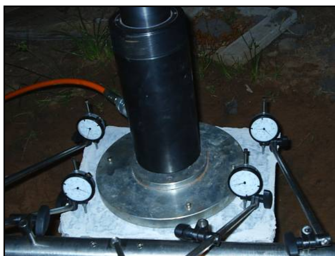
Figura 3. 8 - Disposi o dos deflet metros sobre o bloco
