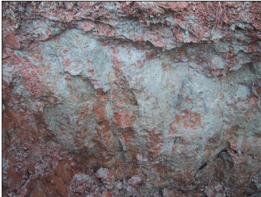
Figura 4. 4 - Trincheira TP-1 aberta para retirada de amostras indeformadas (Emmer, 2004)
