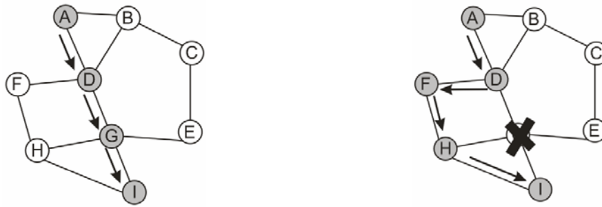
Figura 02 – Roteamento em redes ad hoc. Fonte: Adaptado de Tanenbaum, 2003.
