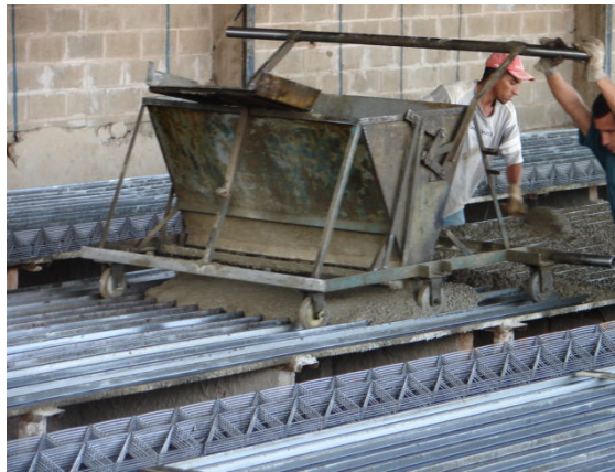
Figura 2.9 - Lançamento do concreto por mecanismo criado em fábrica. Fonte: Figueiredo e Shiramizu (2011).
