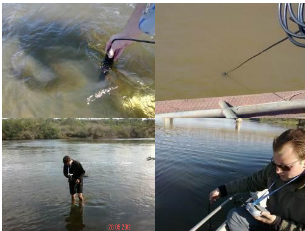
Figura 12 - Sonda Multiparâmetro e sua dinâmica de utilização.
