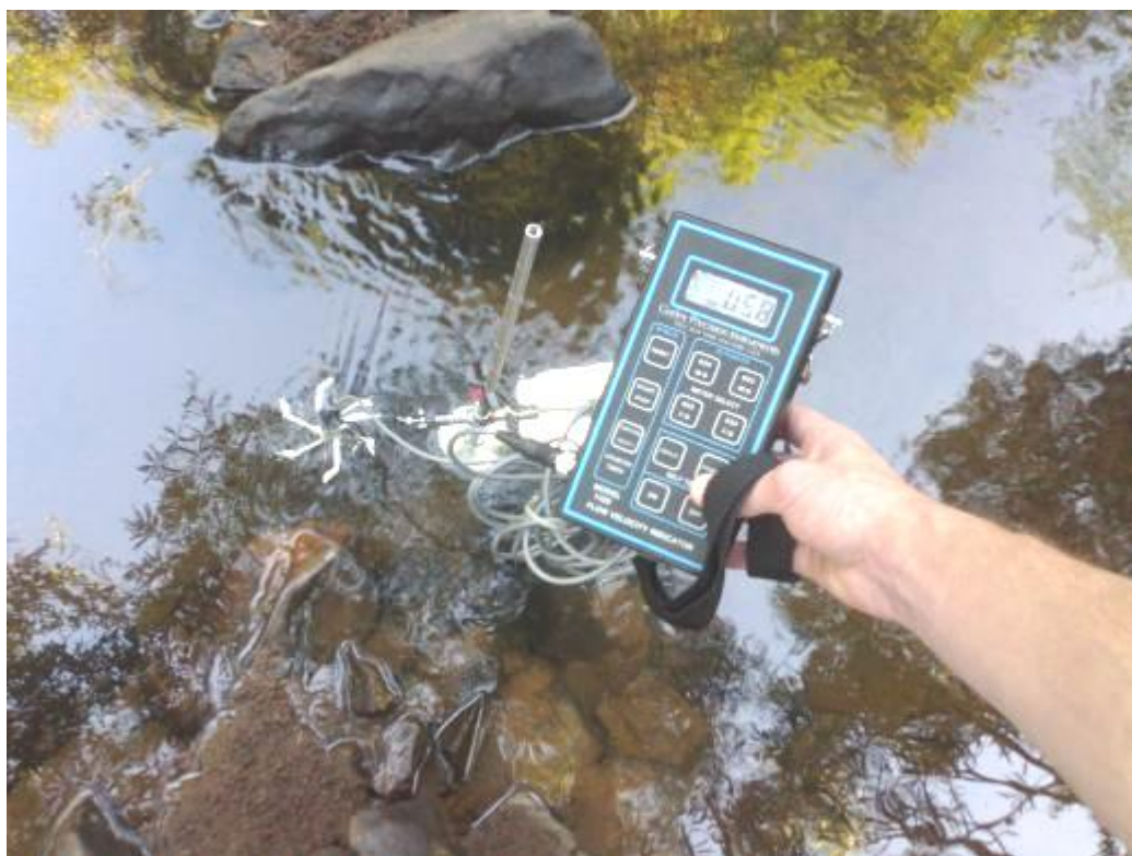
Figura 14 – Molinete Gurley utilizado nas medições de vazão no Lajeado das Pedras.
