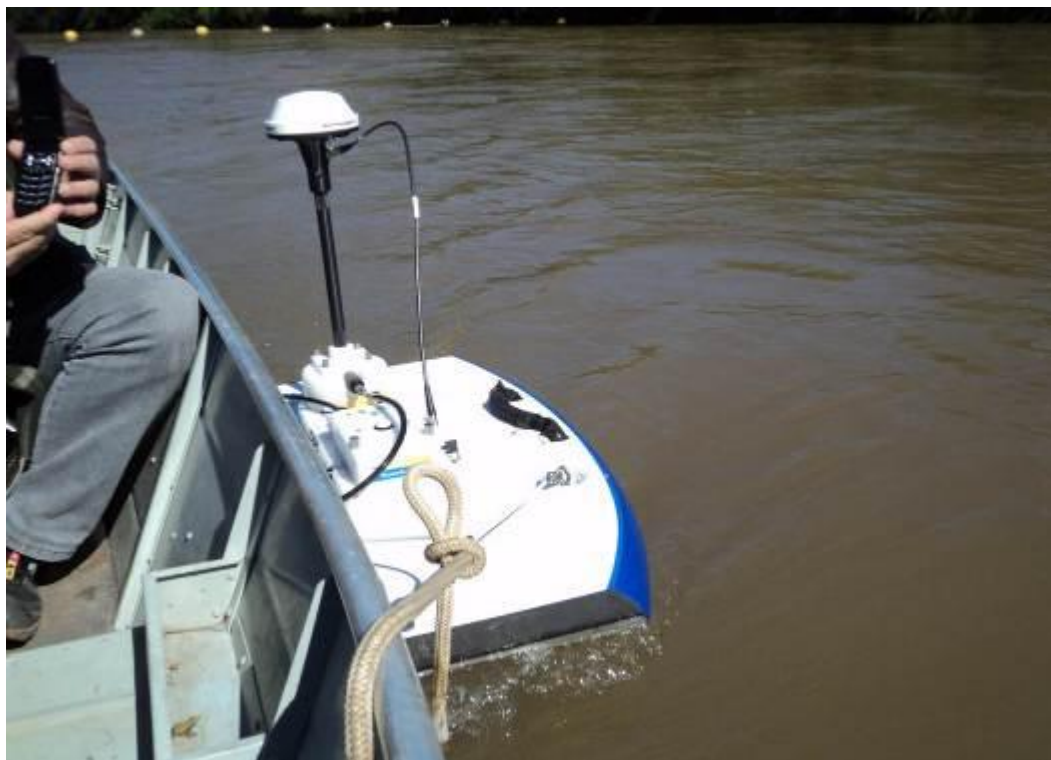
Figura 15 – Utilização do Acoustic Doppler Current Profiler (ADCP).
