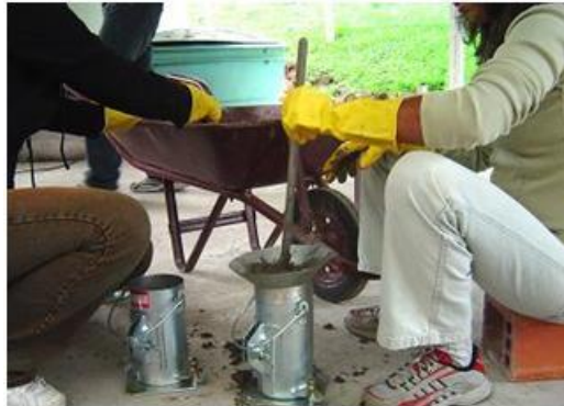
Figura 4.6 – Procedimentos para realização do slump test .
