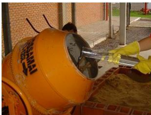
Figura 4.5 – Adição de água a mistura.
