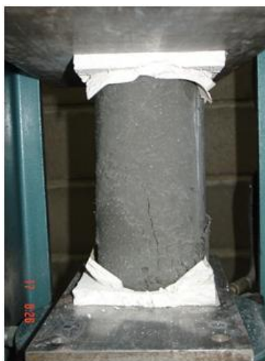
Figura 4.10 – Detalhe do rompimento do corpo-de-prova.
