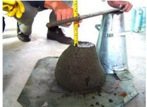
Figura 4.7 – Medição do Slump test .
