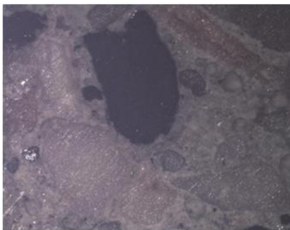
Figura 5.8 – Interação com o resíduo de borracha.
