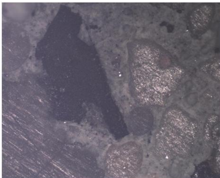
Figura 5.9 – Interação com o resíduo de borracha tratada.
