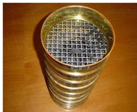
Figura 4.3 – Ensaio de granulometria da borracha.
