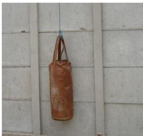
Figura 2.29 – Saco cilíndrico de couro preenchido com areia, 40 kg.
