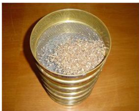
Figura 4.2 – Ensaio de granulometria da areia.
