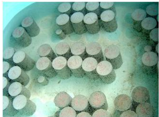
Figura 4.9 – Corpos-de-prova curados em água.
