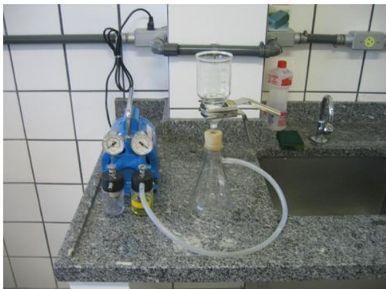
Figura 4.13 – Sistema de filtração sob vácuo utilizado.
