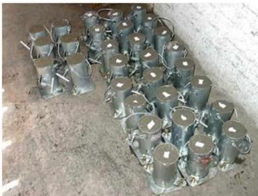
Figura 4.8 – Corpos-de-prova após moldagem.
