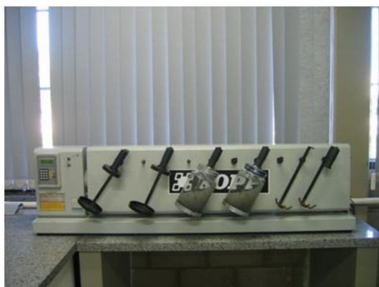
Figura 4.14 – Agitador de frascos tipo “Rollover”.
