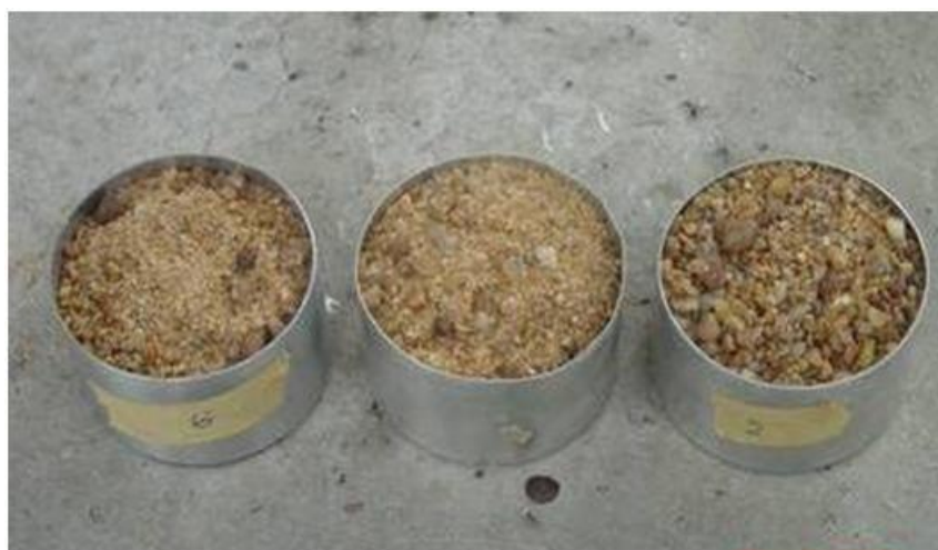
Figura 4.1 – Amostras de areia para medição do percentual de umidade da areia.
