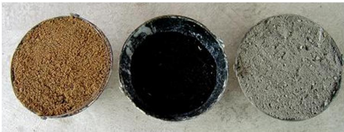
Figura 4.4 – Material utilizado na composição dos traços: areia, borracha e cimento, respectivamente.
