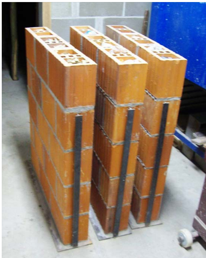
Figura 24– Paredes moldadas para realização dos ensaios principais.
