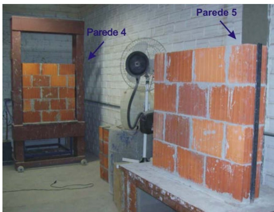
Figura 25 – Paredes moldadas para realização do ensaio à compressão.
