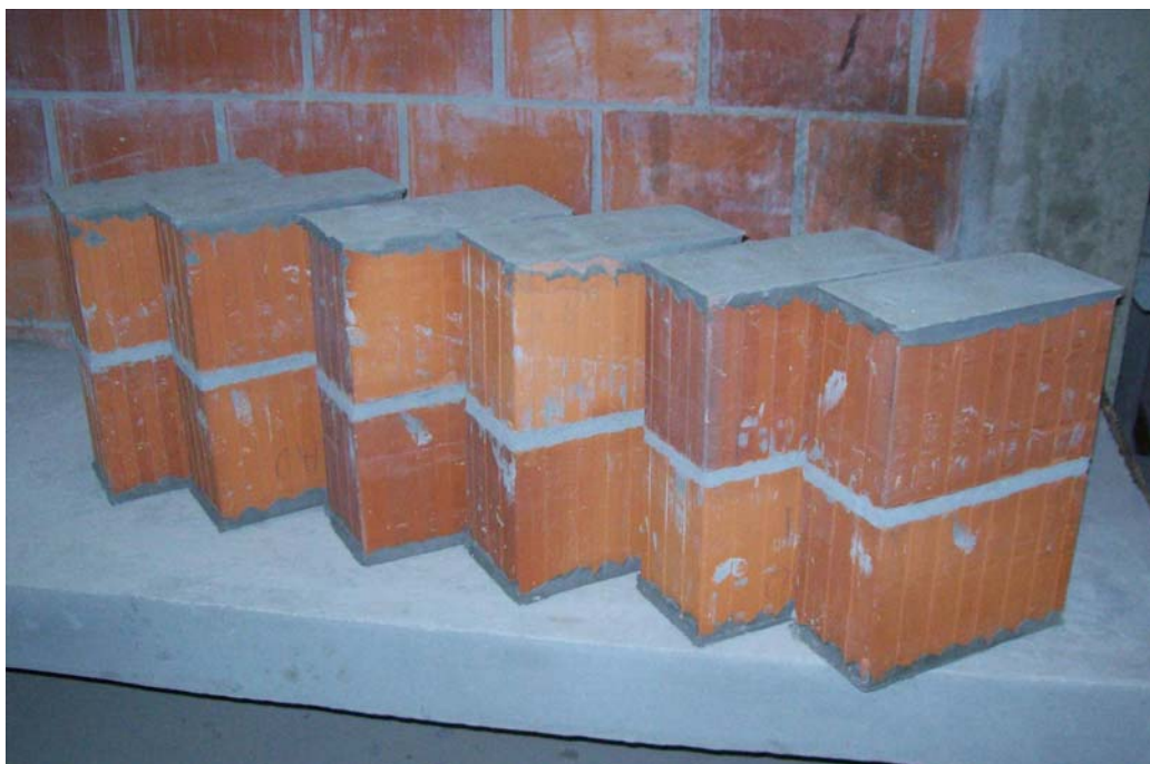
Figura 23– Prismas moldados para ensaio à compressão.
