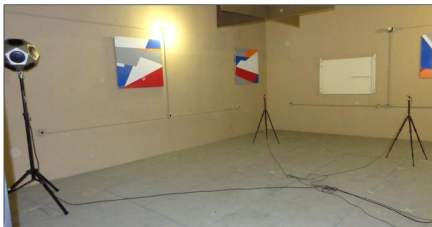
Figura 4.1– Esquema ensaio câmara reverberante vazia
