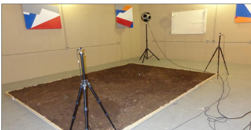
Figura 4.2– Esquema ensaio câmara reverberante com amostra
