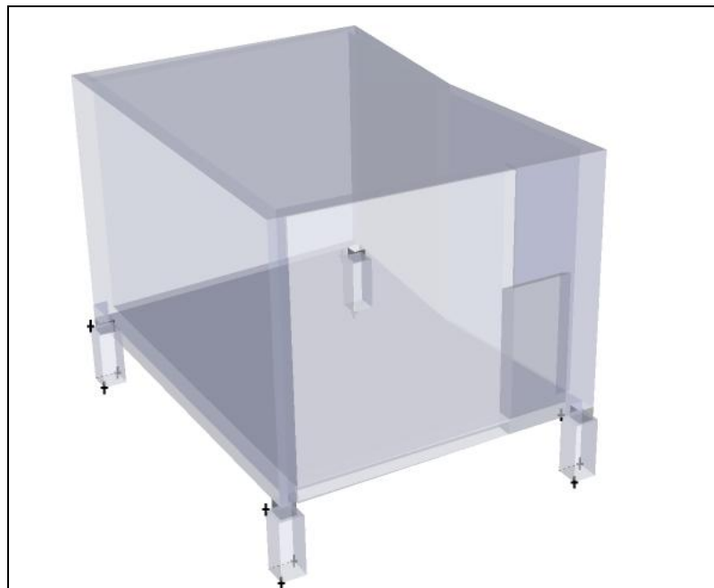
Figura 3.2 – Esquema Perspectiva Câmara Reverberante UFSM
