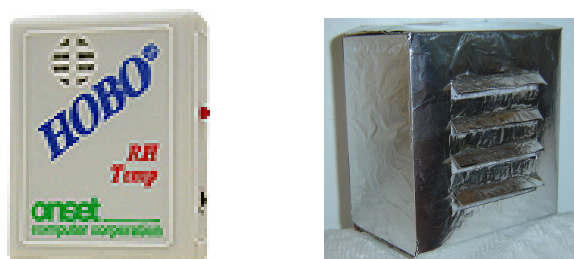
Figura 9 - Aparelho de medição e sua proteção contra a radiação
