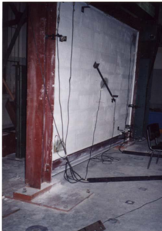
Figura 3.2 – Ensaio do pórtico preenchido. Fonte: Alvarenga, 2002.
