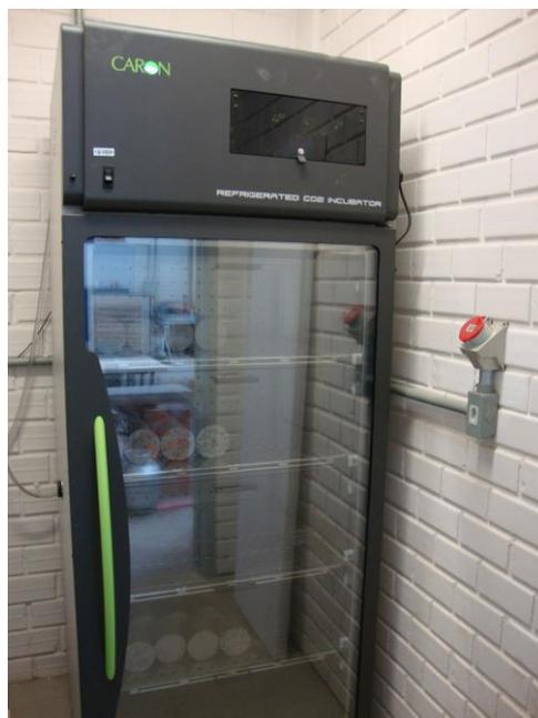
Figura 27 - Câmara de carbonatação.
