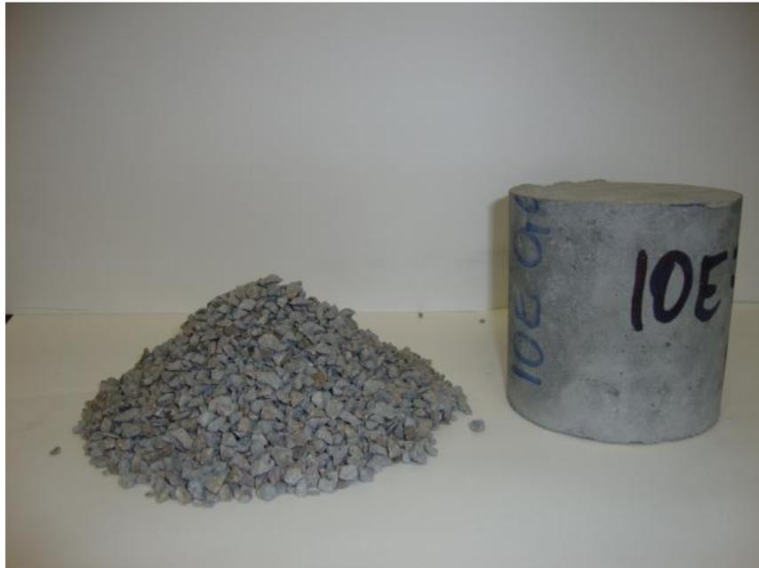
Figura 25 - Corpo-de-prova parte moída e inteira.
