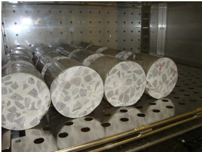
Figura 29 - Corpos-de-prova na câmara de carbonatação.
