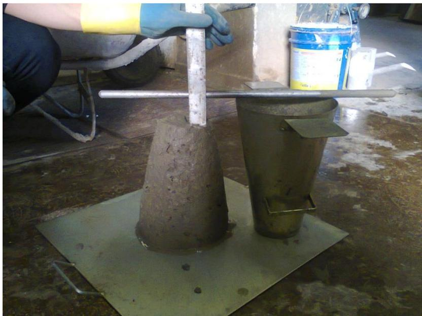
Figura 12 - Ensaio do Tronco de cone. Fonte: Ensaios realizados no LMCC (UFSM).
