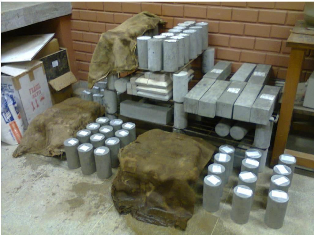
Figura 18 - Cura com Sacos de Aniagem (Estopas Úmidas)
