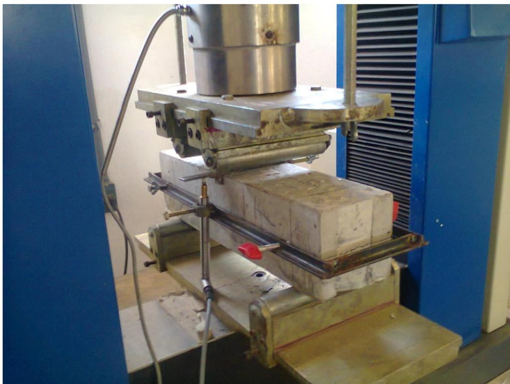
Figura 21 - Ensaio de tração na flexão com o suporte “Yoke” e um LVDT para medida do deslocamento.
