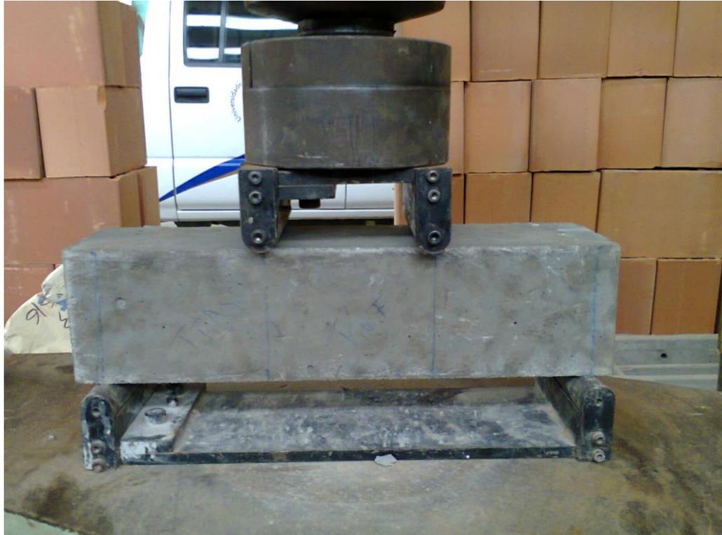
Figura 19 - Ensaio de Tração na Flexão
