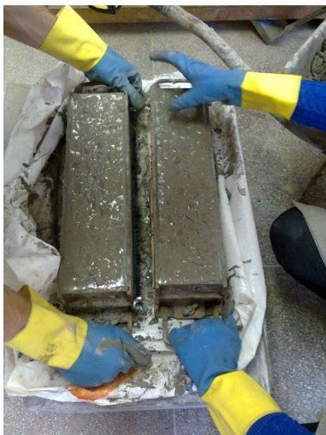
Figura 13 - Corpos de prova prismáticos sendo adensados na mesa vibratória. Fonte: Ensaios realizados no LMCC (UFSM)
