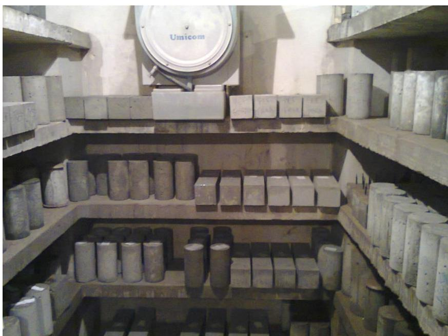
Figura 16 - Cura em Câmara Úmida
