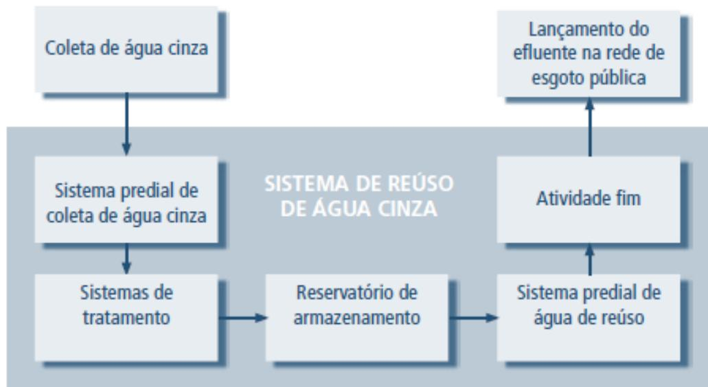
Figura 3-2 – Sistema de reúso de águas cinzas.
