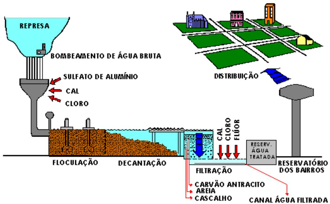
Figura 3-1 – Esquema de um sistema de abastecimento de água de ciclo completo.
