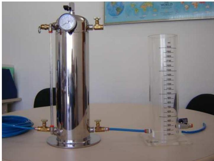
Figura 4-4 – Saturador de bancada
