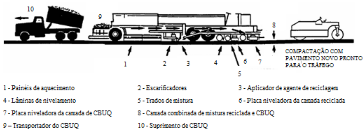
Figura 23 – Esquema do processo de repavimentação por single-pass
