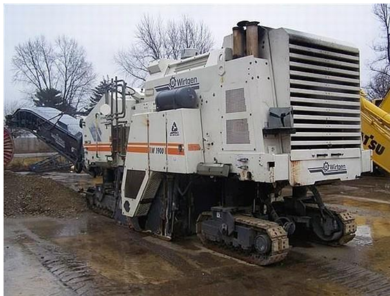
Figura 8 – Fresadora W 1900 da Wirtgen
