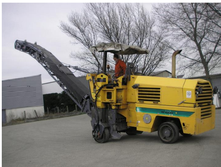
Figura 7 – Fresadora W 1000 da Wirtgen
