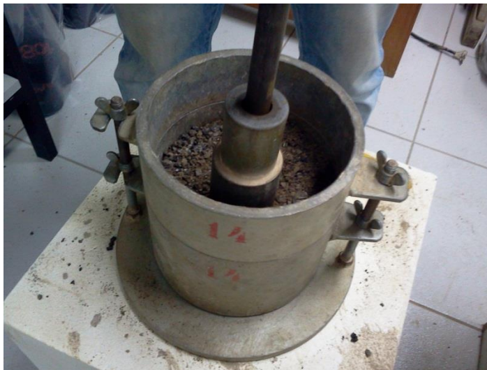
Figura 50 – Mistura estabilizada granulometricamente em ensaio de compactação
