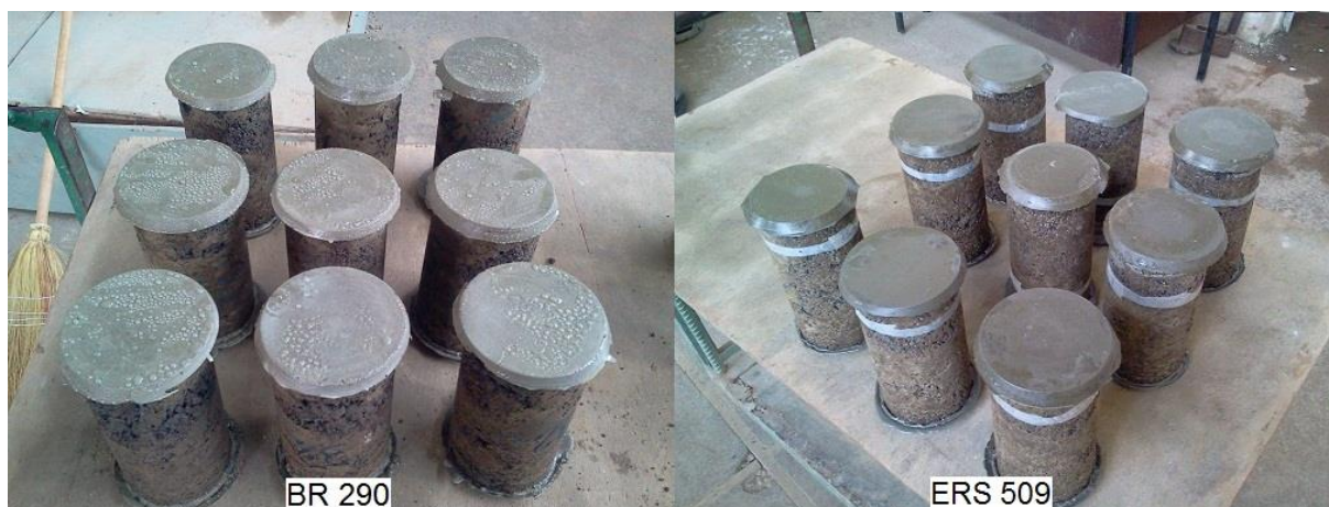
Figura 33 – Corpos de prova para ensaio de RCS com diferentes teores de cimento Portland
