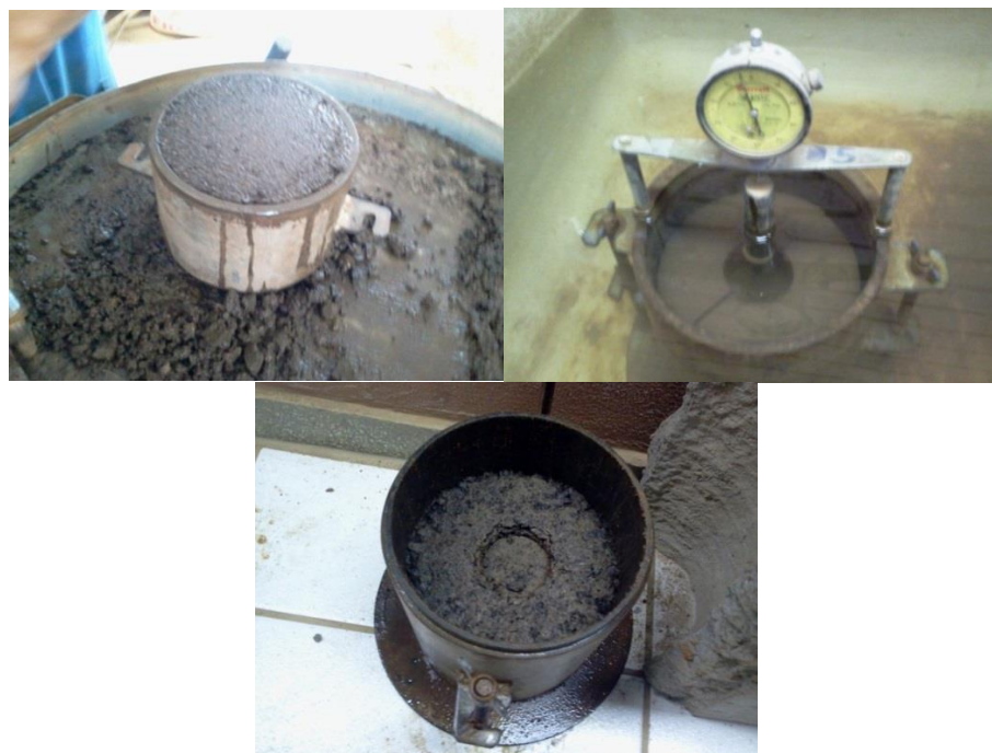
Figura 51 – Relato fotográfico no ensaio de determinação do ISC em mistura estabilizada granulometricamente
