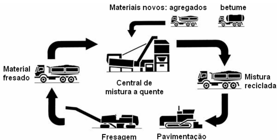
Figura 28 – Esquema do processo de reciclagem a quente em usina.
