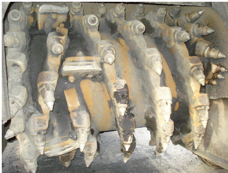
Figura 37 – Detalhe do cilindro de corte da fresadora Caterpillar PM102
