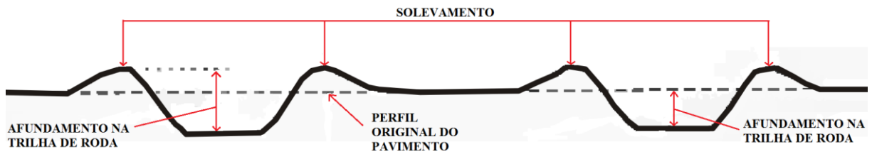
Figura 23 - Esquema da deformação permanente na trilha de roda
