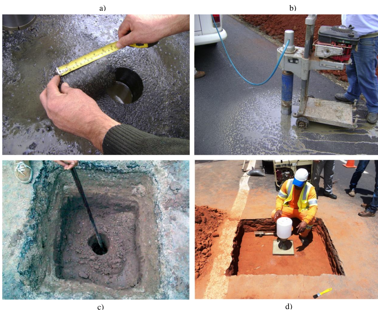
Figura 3 - Extração de corpos de prova (a e b); poços de sondagem no pavimento (c e d)
