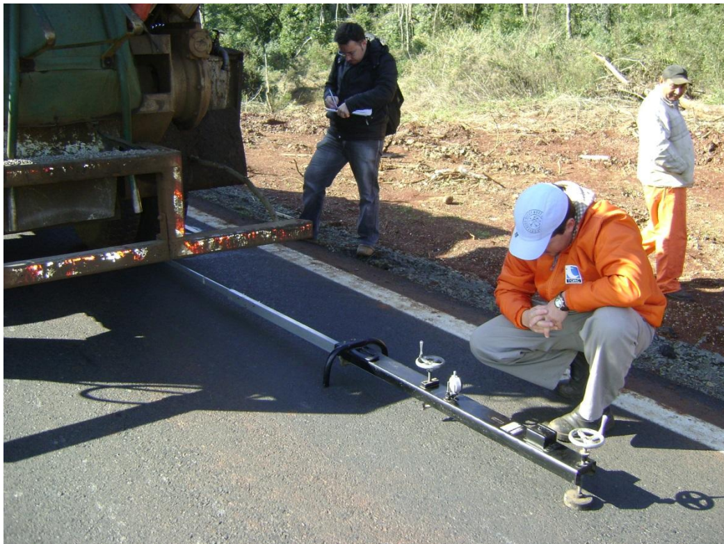
Figura 8 - Realização do ensaio com a viga Benkelman
