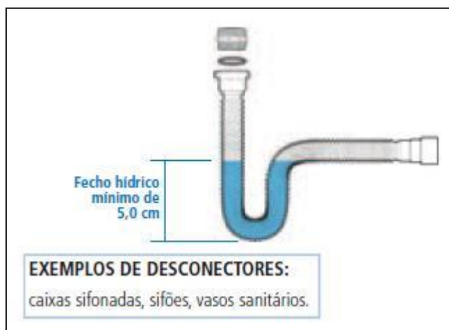
Figura 2.6 – Exemplo de sifão com fecho hídrico. Fonte: TIGRE, 2013, p 113.
