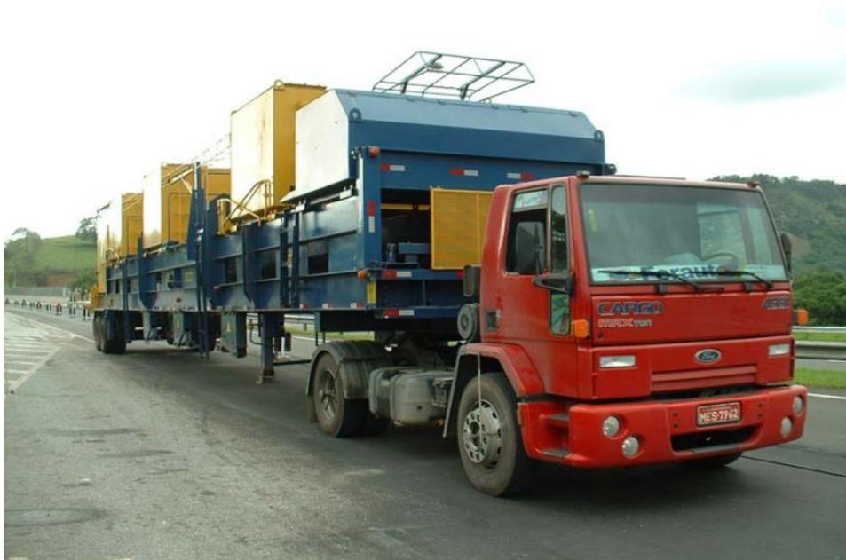
Figura 2.5: Simulador de tráfego móvel - HVS
