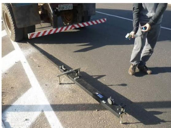
(c) Medição da temperatura da pista
