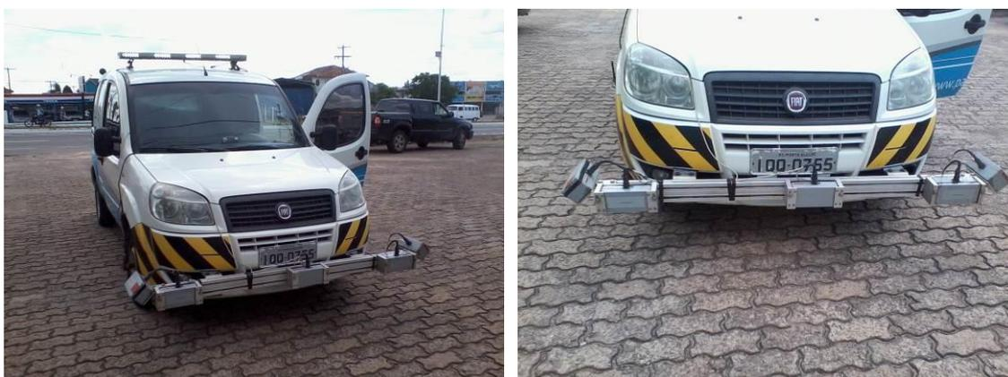
Figura 3.34: Veículo com barra que contém cinco sensores a laser
