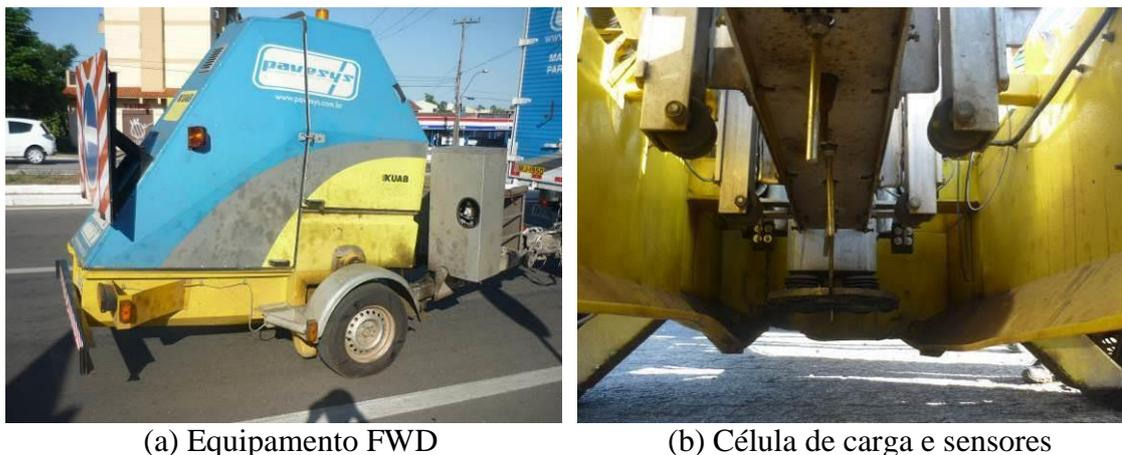
Figura 3.38: Equipamento para obtenção de deflexões por FWD marca Kuab
