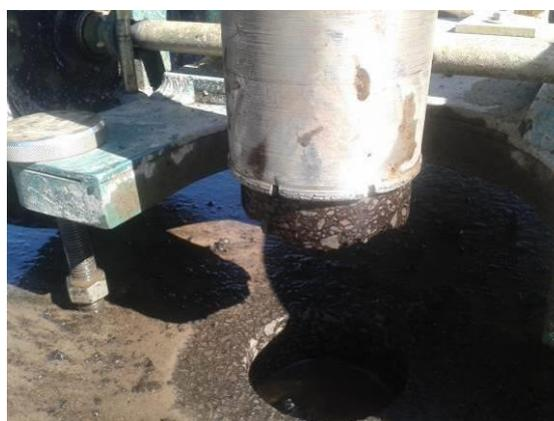
(b) Remoção do testemunho da broca
