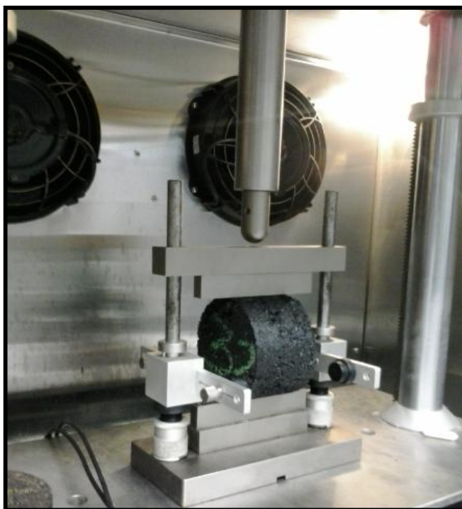
Figura 17 – Ensaio de fadiga por compressão diametral de corpos-de-prova
