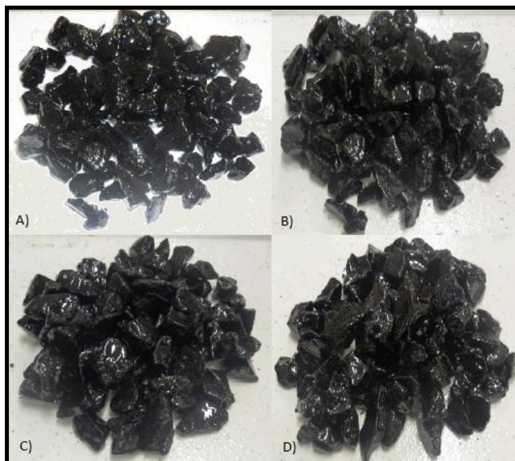
Figura 36 – CAP 60/85-E: A) Agregados sem Dope; B) Agregados com 0,04% de Dope; C) Agregados com 0,08% de Dope; D) Agregados com 0,12% de Dope.
