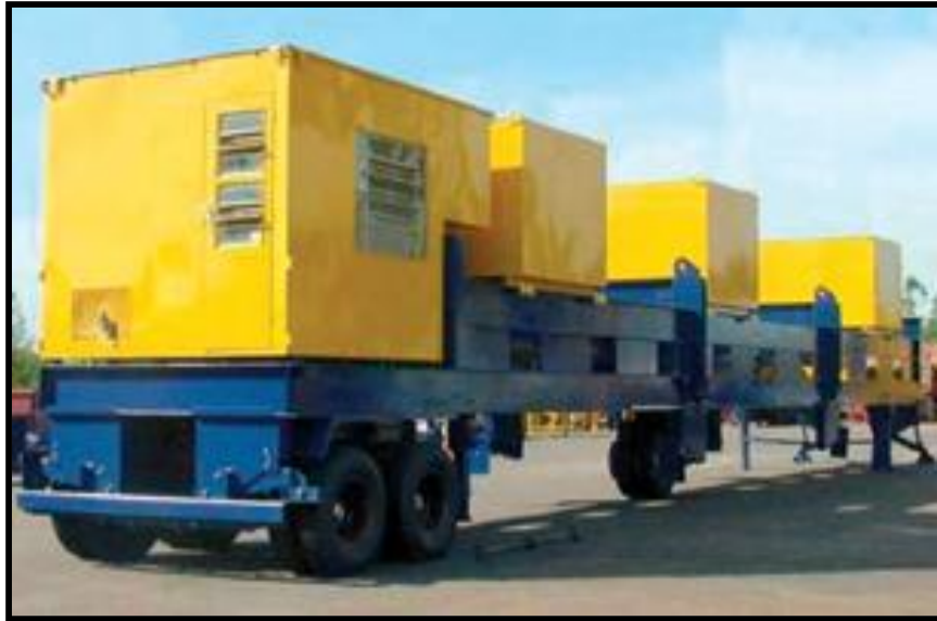
Figura 28 - Simulador de tráfego brasileiro móvel do tipo HVS
