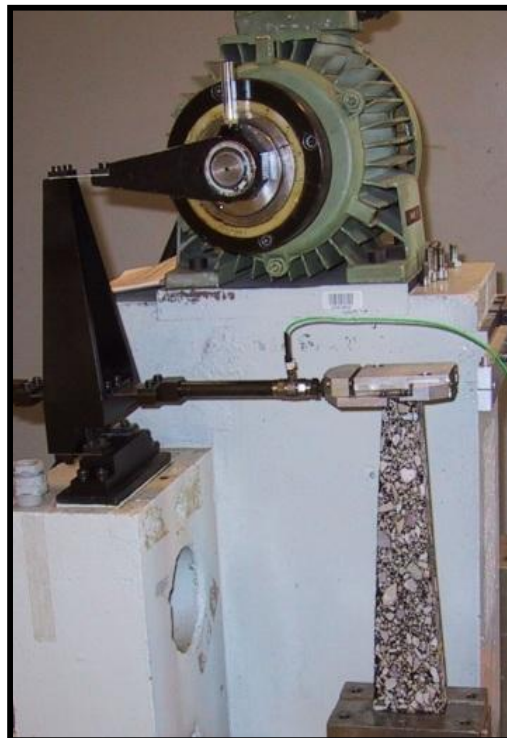
Figura 20 - Ensaio de fadiga realizado por flexão em amostras trapezoidais
