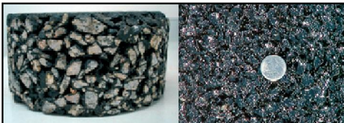
Figura 3 – Exemplo de mistura asfáltica usinada a quente do tipo CPA
