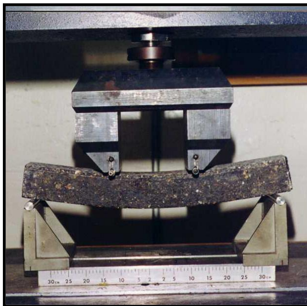
Figura 19 - Ensaio de fadiga por flexão em viga à deformação controlada
