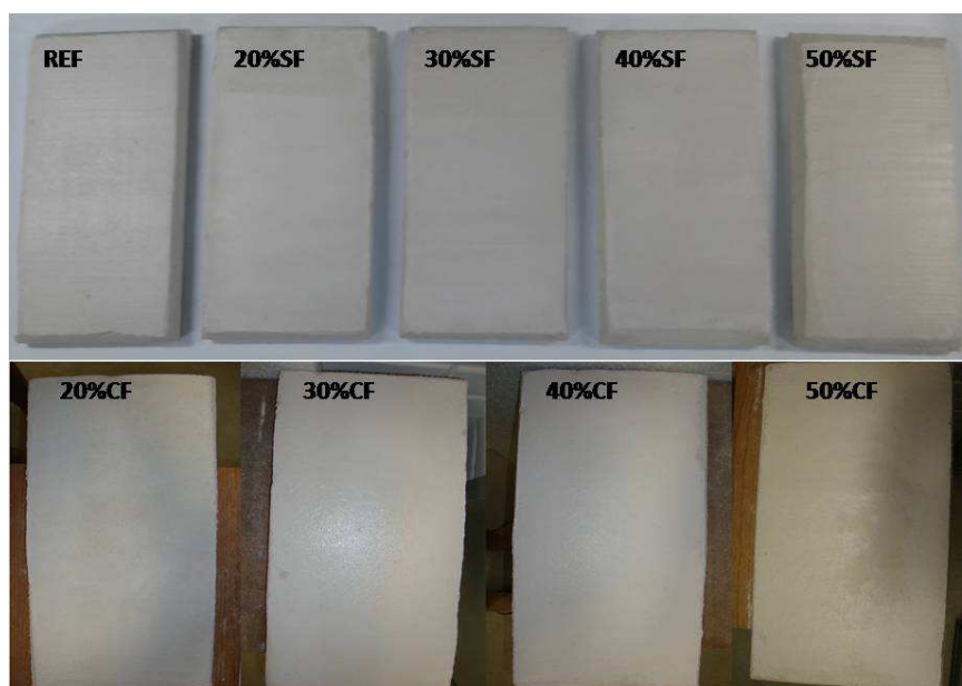
Figura 44 – Argamassas produzidas: todas sem fissuras
