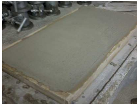
Figura 24 – Moldagem das argamassas sobre substratos de concreto
