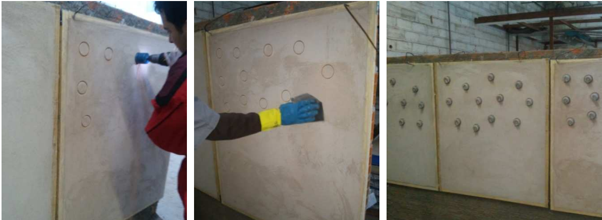
Corte a seco, limpeza e pastilhas coladas
