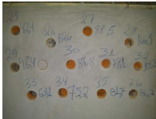
Figura 55 – Argamassa de referência, rupturas predominantes do tipo A e D
