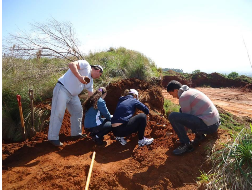
Figura 3.1 - Coletas das amostras indeformadas
