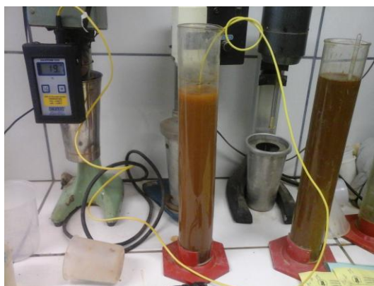
Figura 3.3 - Execução do ensaio da análise granulométrica
