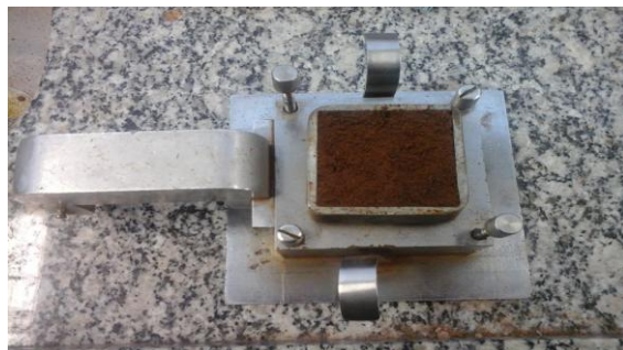
Figura 3.4 - Preparação da amostra para a realização do ensaio de cisalhamento direto
