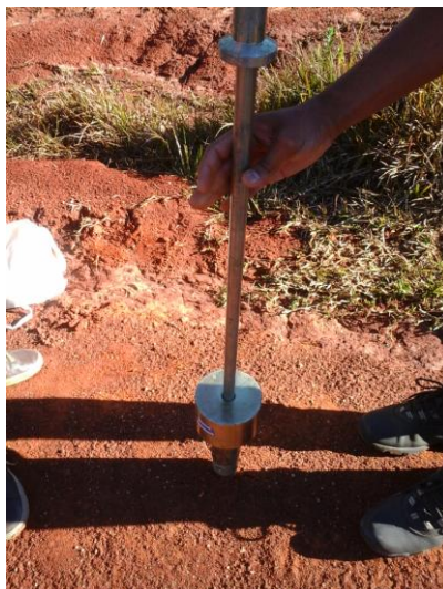
Figura 3.2 – Execução do ensaio do Penetrômetro Dinâmico de Cone (DCP) em campo (ALVES, 2002)
