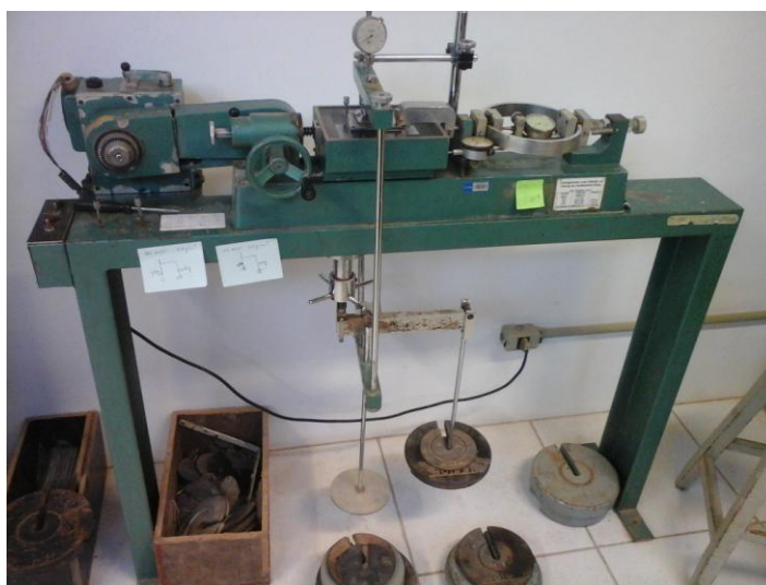
Figura 3.5 - Equipamento utilizado para a realização do ensaio de cisalhamento direto
