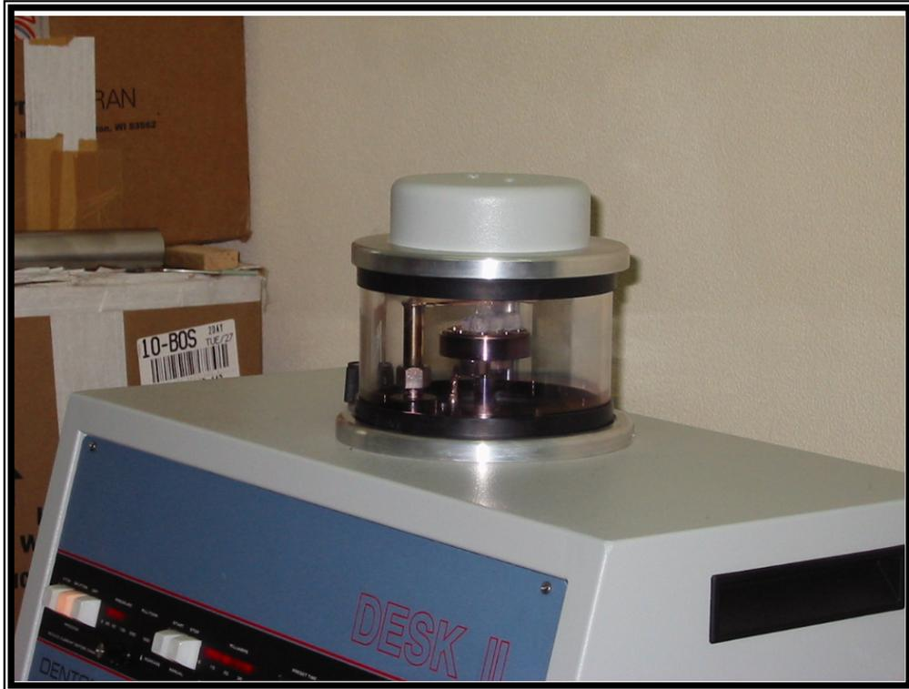
FIGURA 13: Amostras em recipiente à vácuo, sendo pulverizadas com ouro.
