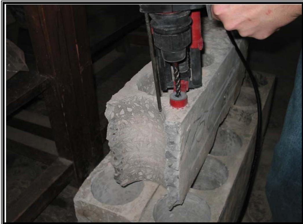
FIGURA 12: Detalhe da extração do pó dos protótipos.
