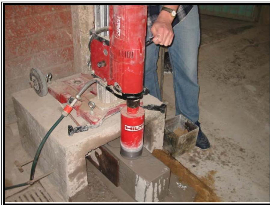
FIGURA 10: Extração dos testemunhos dos protótipos.
