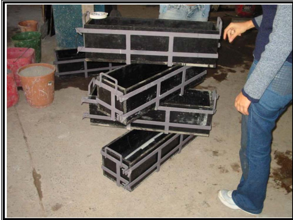
FIGURA 5: Formas já preparadas para a moldagem
