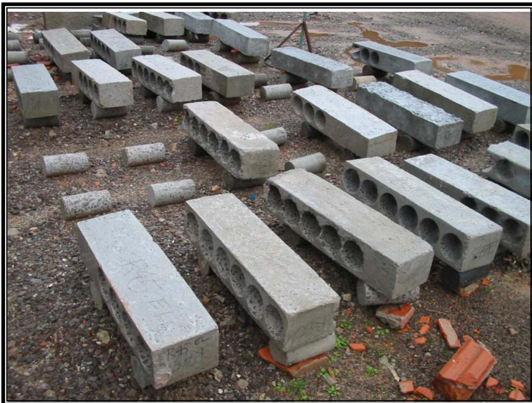
FIGURA 8: Protótipos curando ao ar livre.
