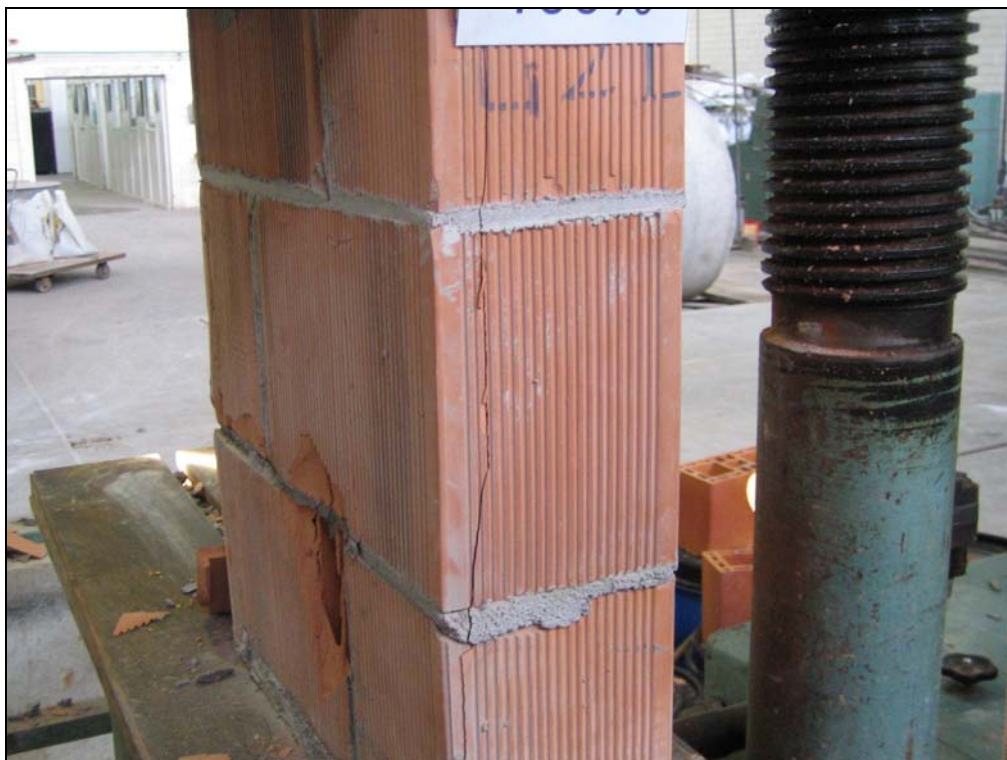
Figura 4.18 – Fissura vertical, prisma 100% grauteado.
