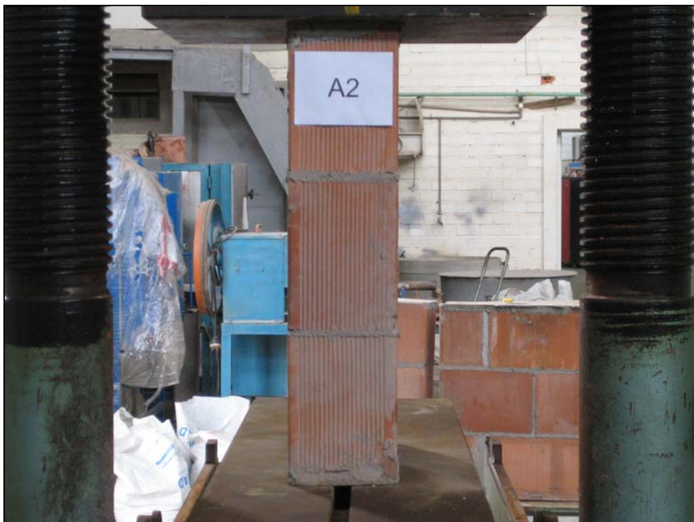
Figura 3.11 – Prisma na prensa para ensaio (perfil).
