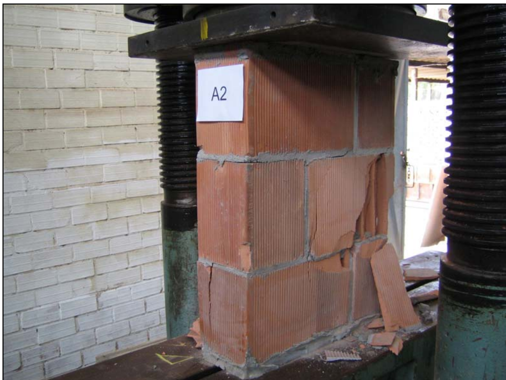
Figura 3.13 – Prisma na prensa, após rompimento.
