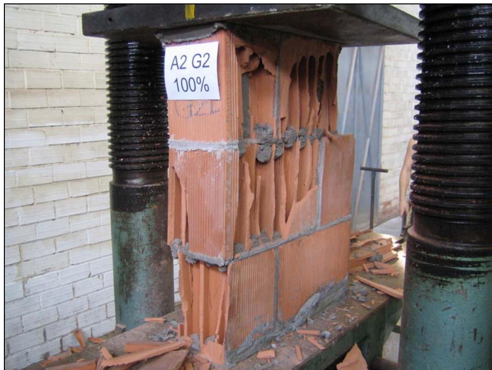
Figura 4.16 – Ruptura explosiva do prisma, argamassa A2.
