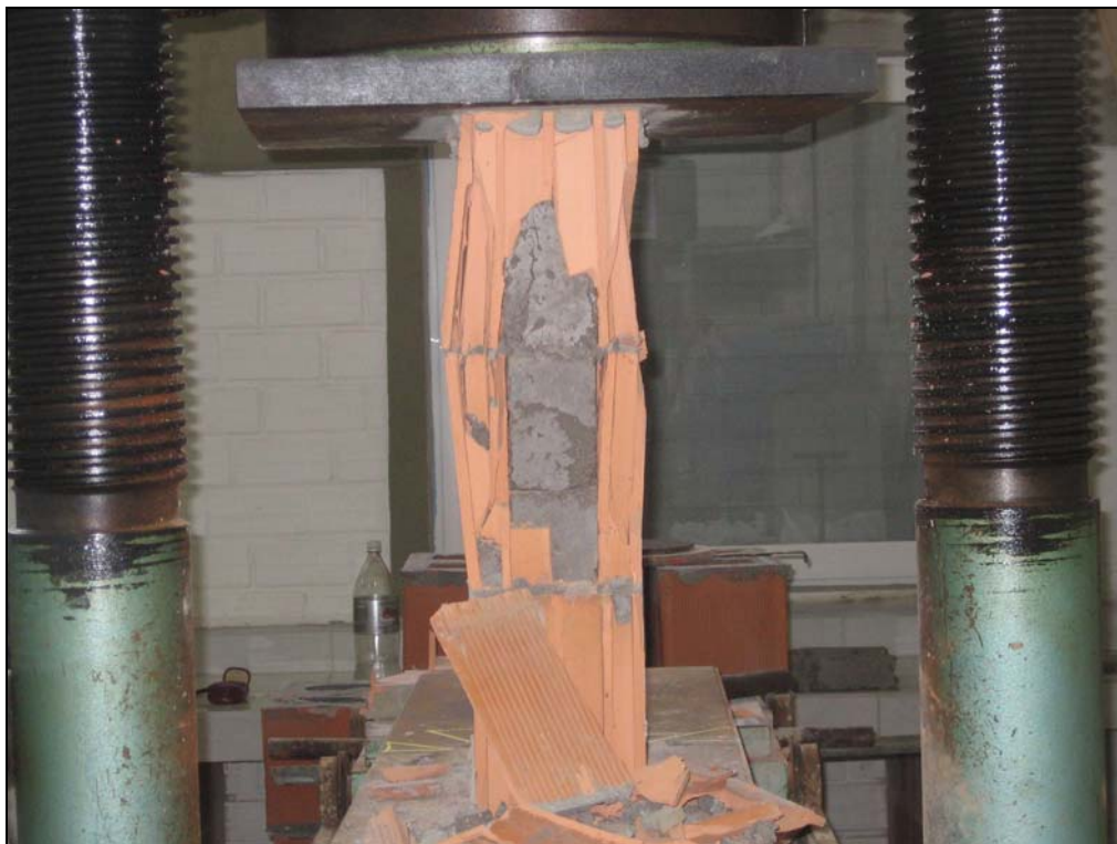
Figura 4.19 – Ação do graute sobre o prisma.
