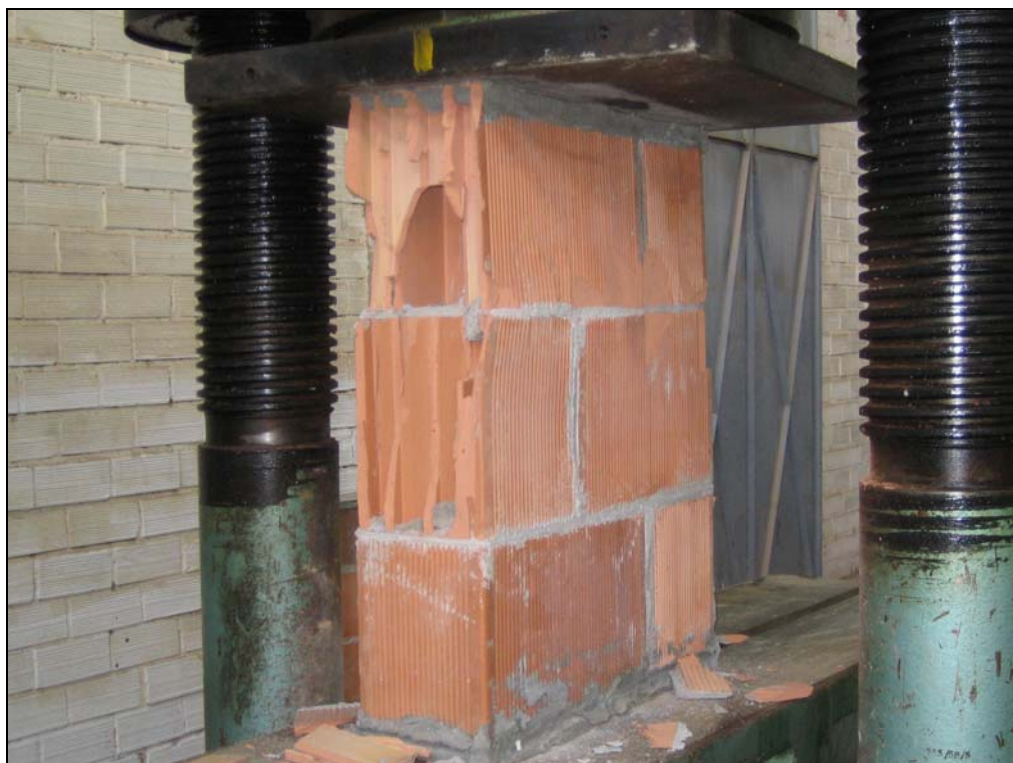
Figura 4.14 – Ruptura lenta do prisma, argamassa A1.
