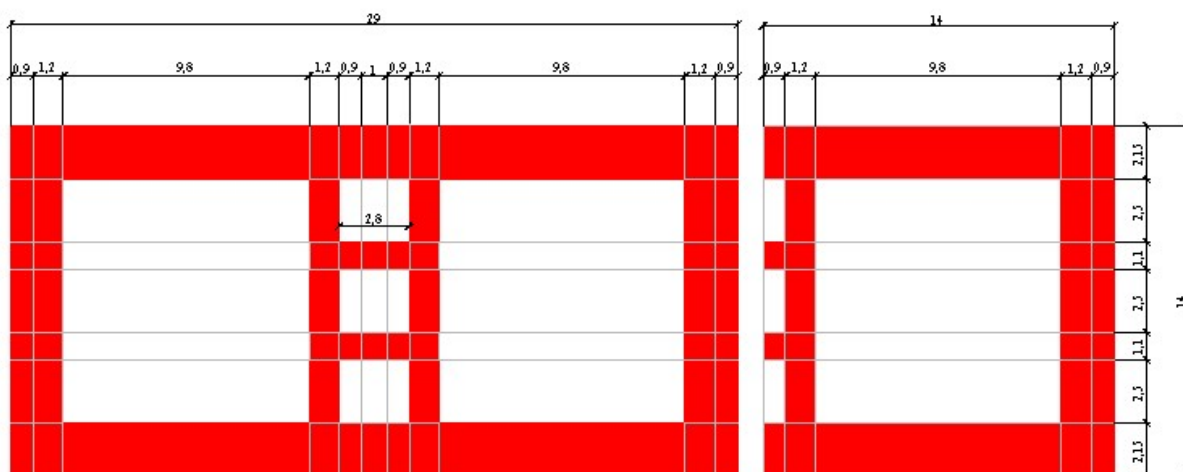
Figura 20 – Dimensões do bloco e meio bloco utilizados na análise numérica, em (cm).
