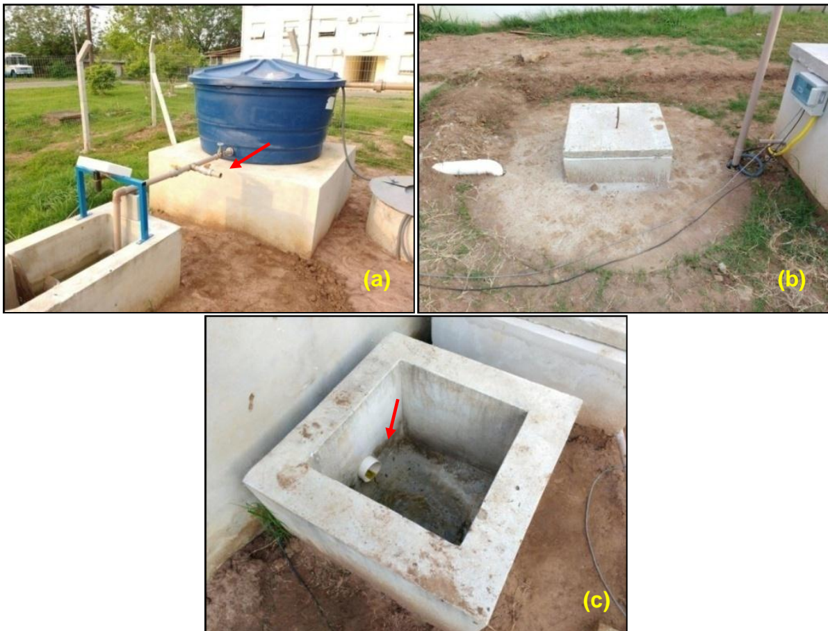
Figura 22 - Locais de coleta: a) Ponto 1 – esgoto bruto; b) Ponto 2 – tanque séptico; c) Ponto 3 – saída do WCFV
