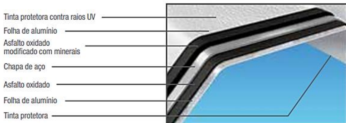
Figura 15 – Ilustração da composição da telha TopSteel.
