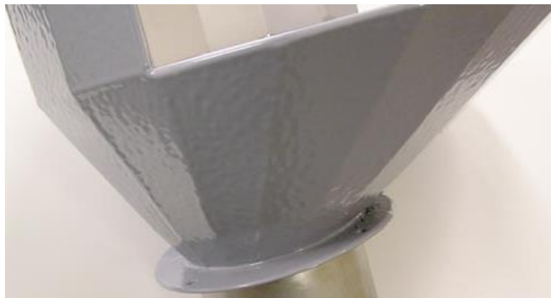
Figura 14 – Imagem da tinta aplicada a uma peça, destaque para a textura final da tinta.
