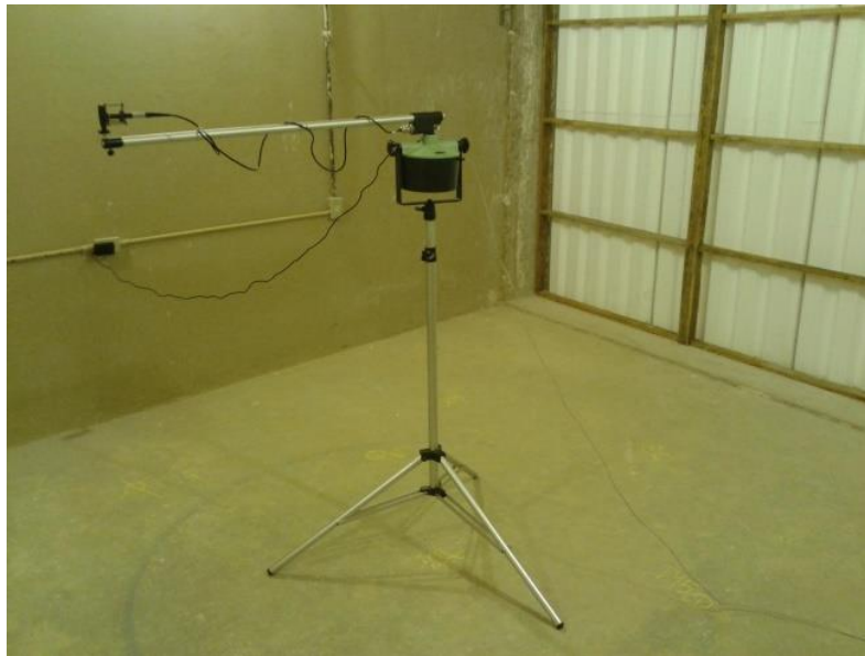
Figura 50 – Vista da montagem do ensaio de PT pela câmara de recepção.
