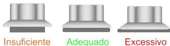
Figura 30 – Indicação do modo de parafusamento.
