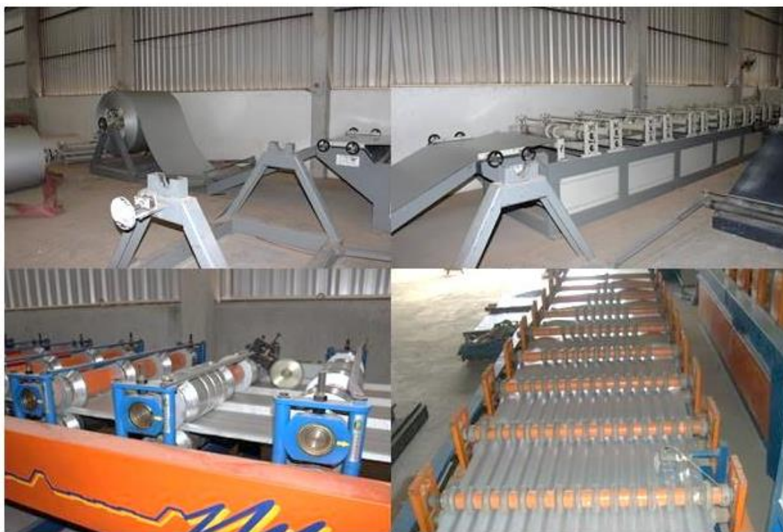
Figura 16 – Processo de perfilação de seção ondulada e trapezoidal.
