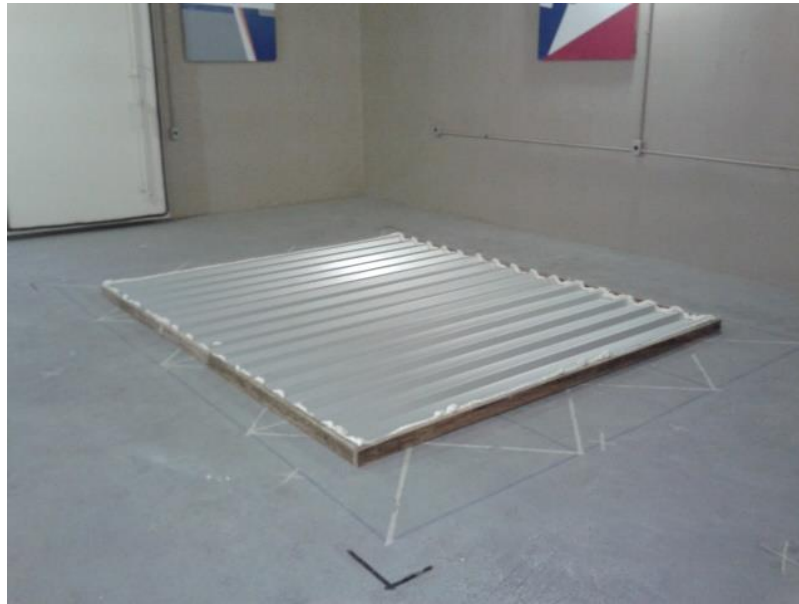
Figura 37 - Imagem do posicionamento da amostra na câmara reverberante.
