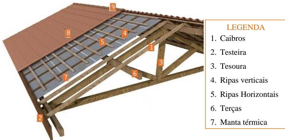
Figura 8 – Esquema da disposição das peças de um telhado de telhas cerâmicas/ concreto.
