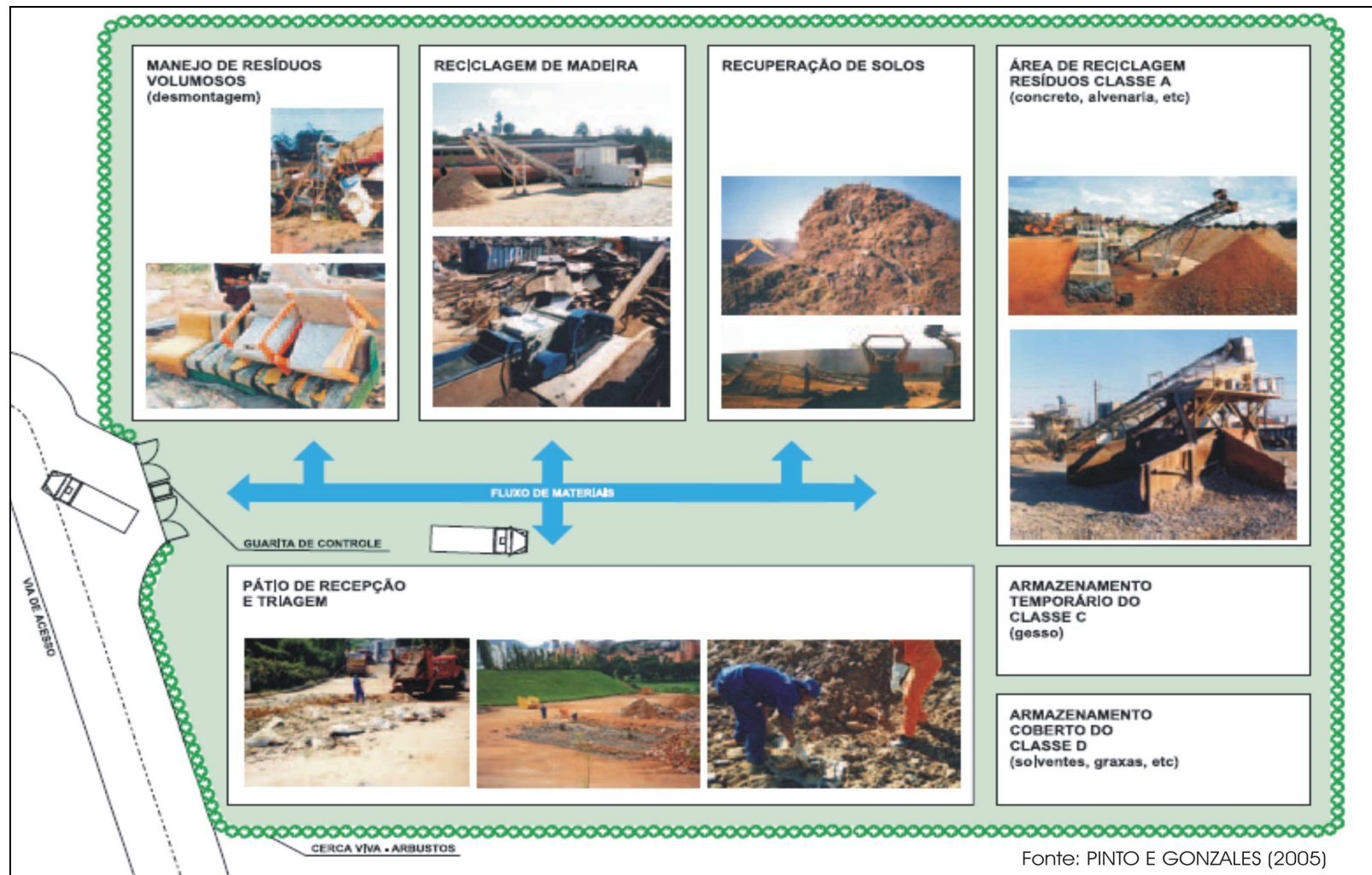
Figura 7 – Sistema de gestão dos RCC numa unidade de reciclagem.
