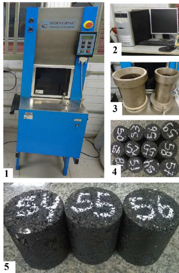
Figura 27 – CGS, computador de aquisição de dados e amostras da dosagem Superpave
