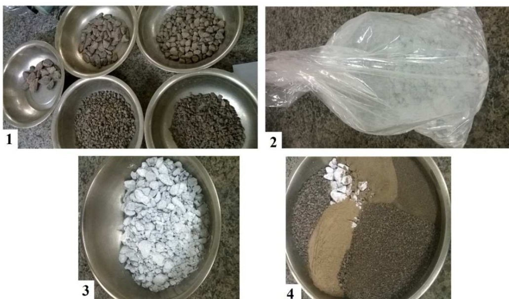
Figura 25 - Pesagem dos agregados e envolvimento da cal com a fração graúda da mistura
