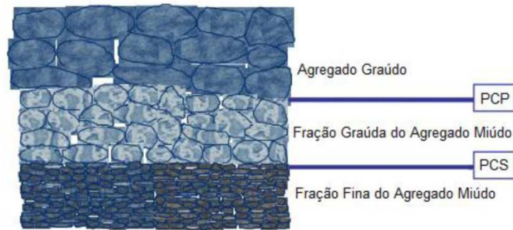
Figura 2 - Visão geral das divisões das peneiras de controle do método Bailey
