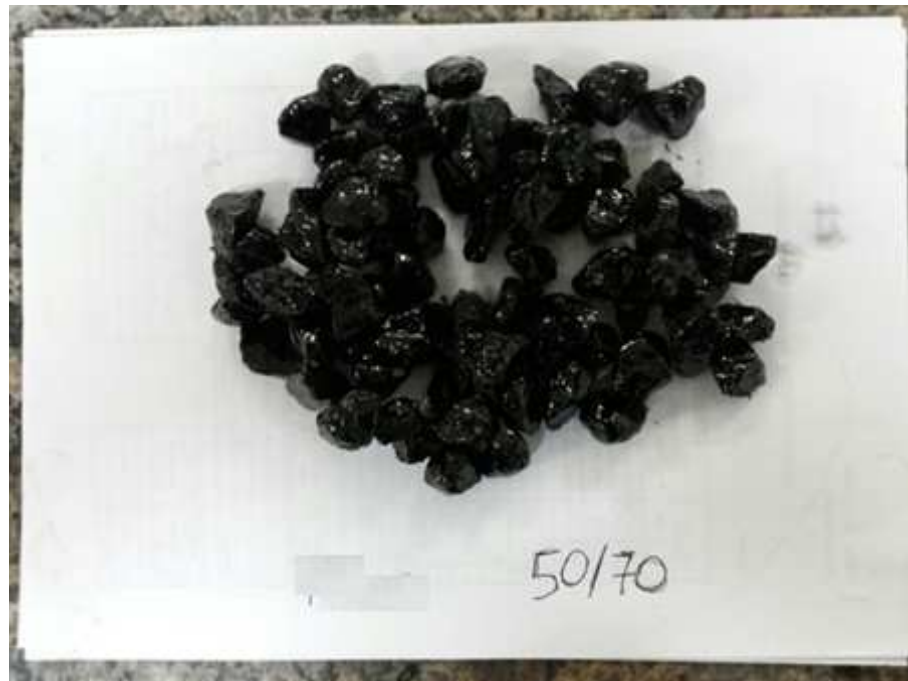
Figura 19 - Ensaio de adesividade CAP 50-70
