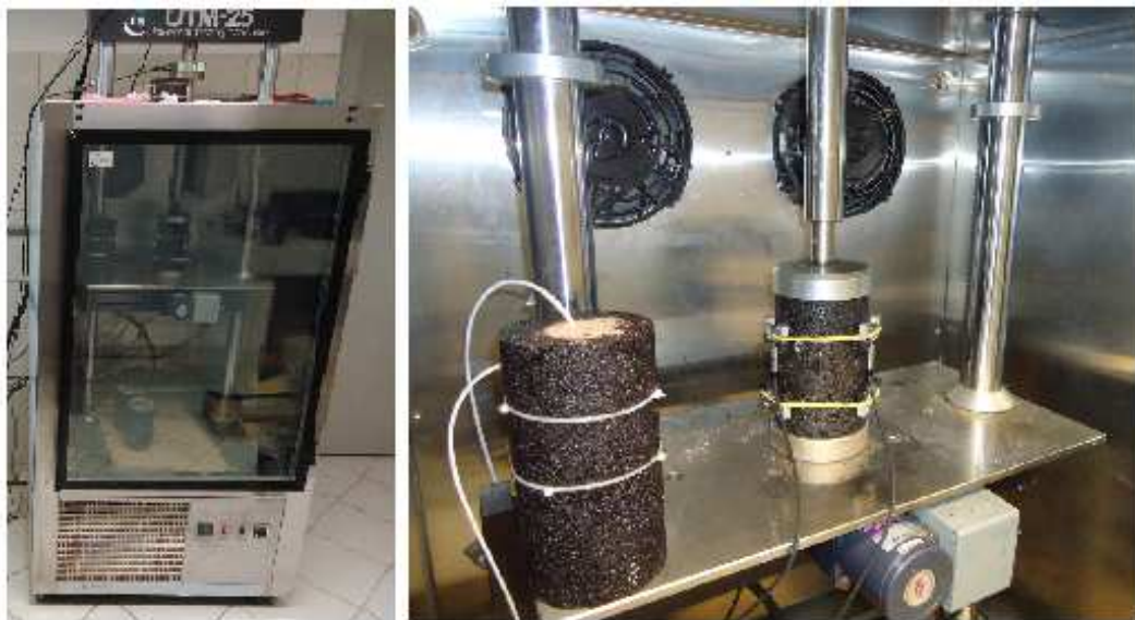
Figura 39 - Amostras condicionadas e ensaiadas a -10°C
