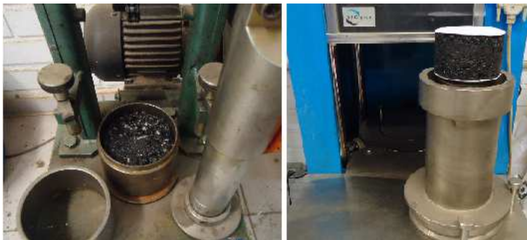
Figura 32 - Amostras para ensaio de MR e RT moldadas compactador Marshall e no CGS
