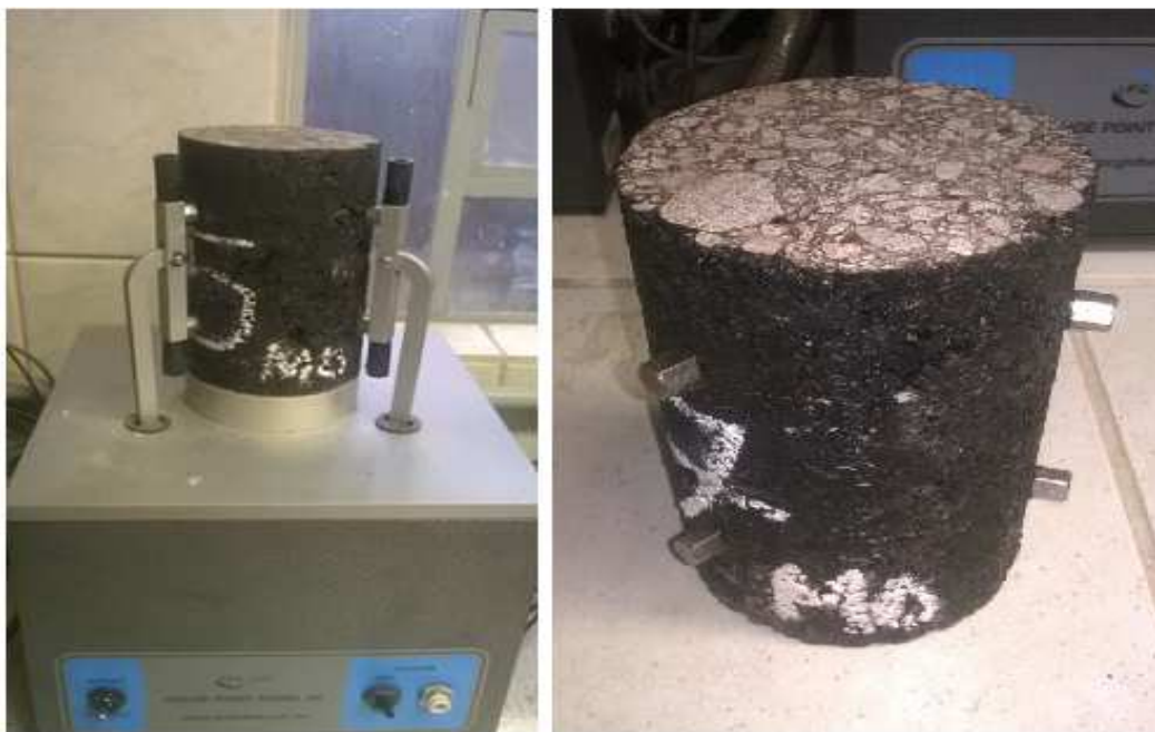
Figura 37 - Colagem dos pinos na amostra de ensaio de E*
