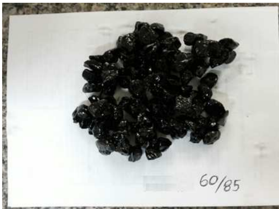
Figura 20 - Ensaio de adesividade CAP 60-85
