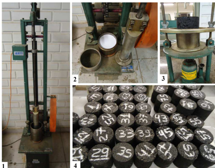
Figura 28 - Compactador Marshall, amostra compactada e extraída e amostras da dosagem
