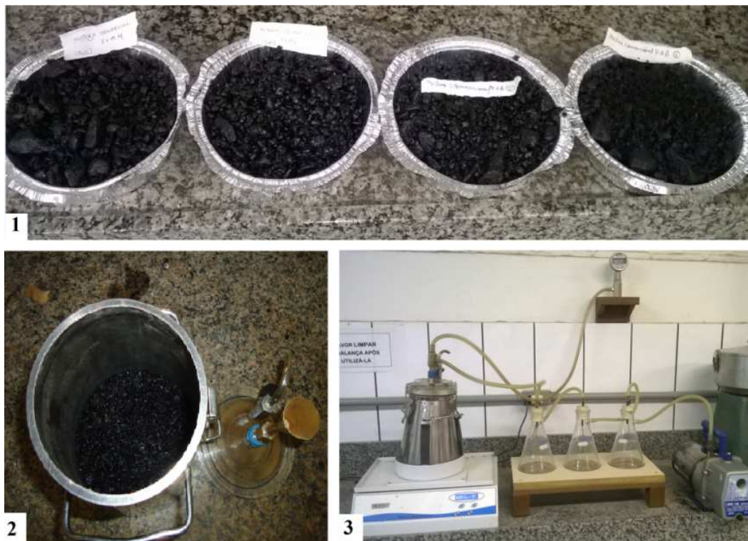
Figura 29 - Determinação da densidade específica máxima das misturas
