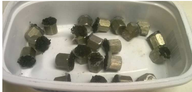
Figura 42 - Descolamento dos pinos fixados ao CP na temperatura de 54°C
