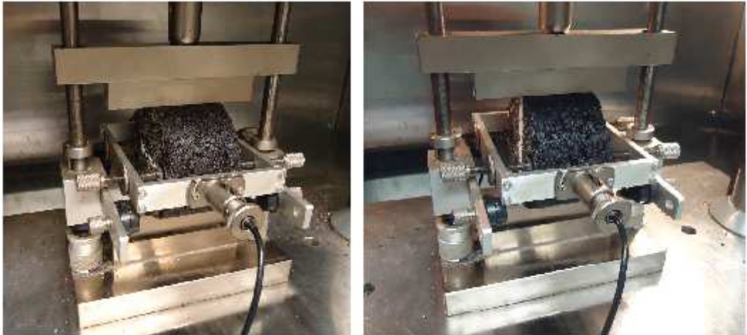
Figura 31 - Ensaio de módulo de resiliência em duas direções: 0° e 90°
