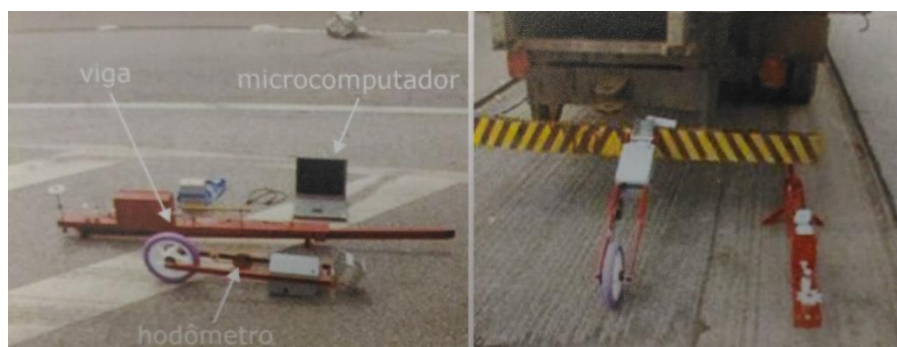
Figura 2.12 – VB eletrônica de leitura automatizada por LVDT
