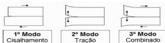
Figura 2.33 – Falha na aderência entre camadas asfálticas
