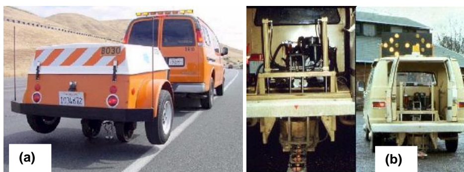
Figura 2.6 – Representação do Dynaflect (a) e Road Rater (b)
