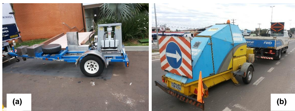
Figura 2.7 – Representação do FWD Dynatest (a) e KUAB FWD (b)
