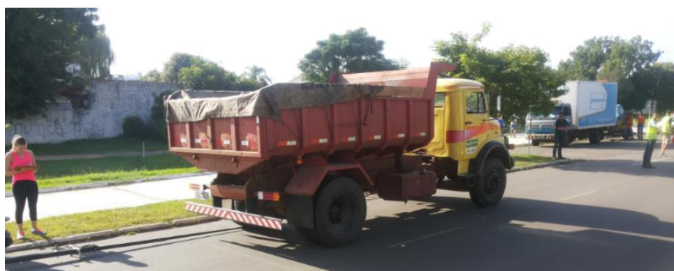
Figura 3.10 – Exemplo de realização do ensaio de VB e posteriormente FWD
