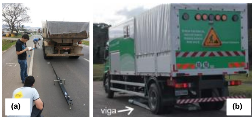
Figura 2.5 – Representação da viga Benkelman (a) e Deflectógrafo Lacroix (b)
