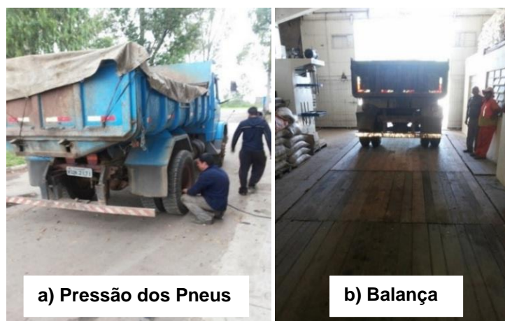
Figura 3.12 – Avaliação das deflexões com a VB em um trecho de Santa Maria/RS
