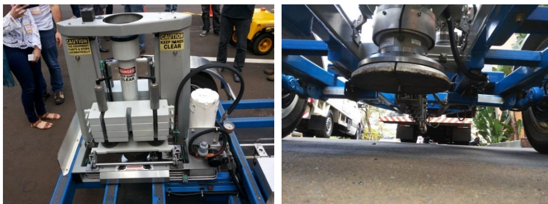
Figura 2.14 – Detalhes do conjunto de massa, placa rígida e geofones no FWD Dynatest
