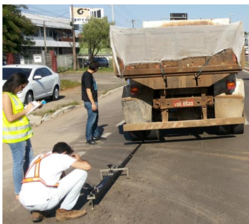
Figura 2.10 – Uso em campo da VB para medição de deflexões de pavimentos em prova de carga com o ESRD de um caminhão
