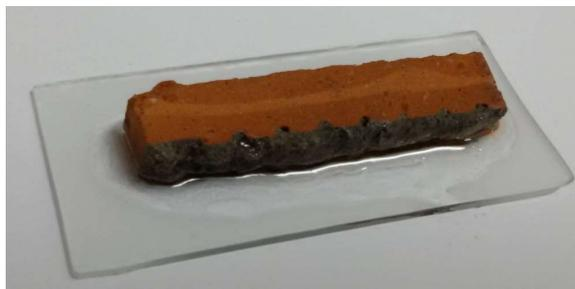
(b) Barra fixada em placa de vidro, para ser lixada e polida
