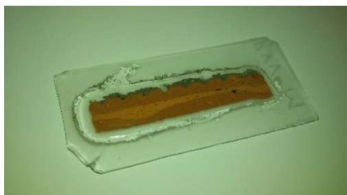
(c) Lâmina contendo a interface bloco cerâmico/chapisco, espessura aproximada de 0,03 mm
