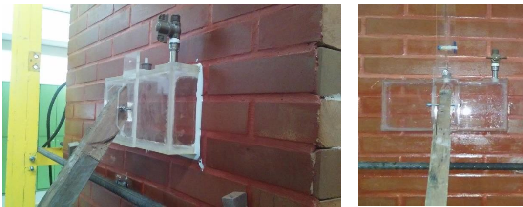
Figura 32 – a e b) Fotos do encaixe da câmara no corpo-de-prova
