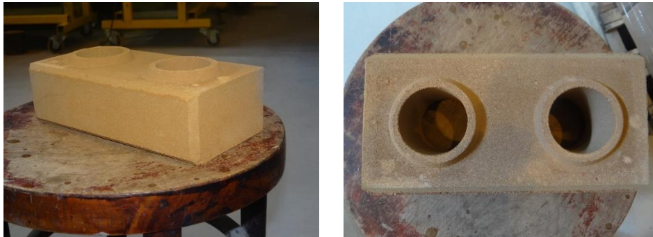
Figura 22 – a e b) Tijolo vazado de solo-cimento em estudo
