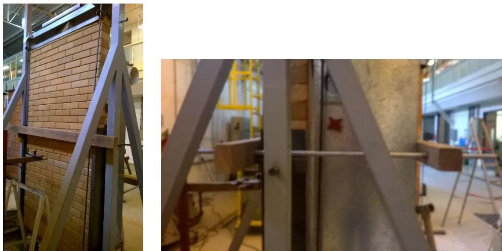
Figura 30 – a e b) Método de fixação do corpo-de-prova
