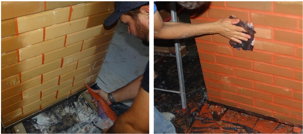
Figura 29 – a e b) Rejuntamento dos corpos-de-prova
