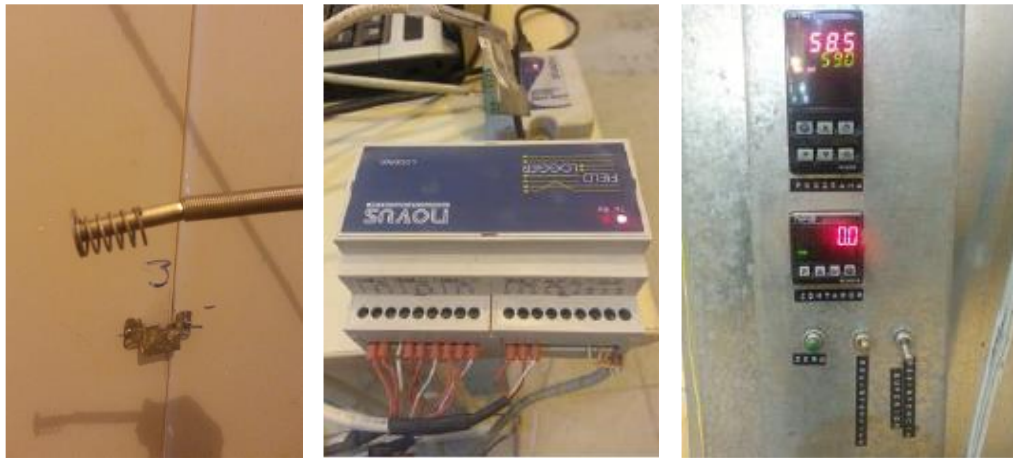
Figura 34 – a) Termopar b) field logger c) controlador
