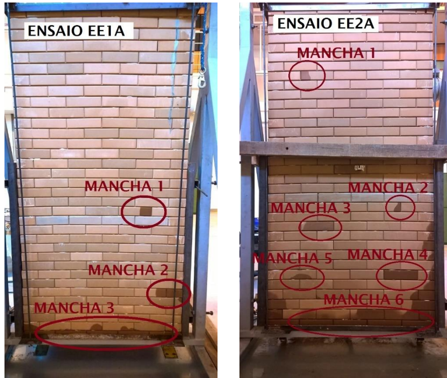
Figura 37 – a) Parede A - Análise visual da face interna após o primeiro (EE1A) e b) segundo (EE2A) ensaio de estanqueidade à água da chuva
