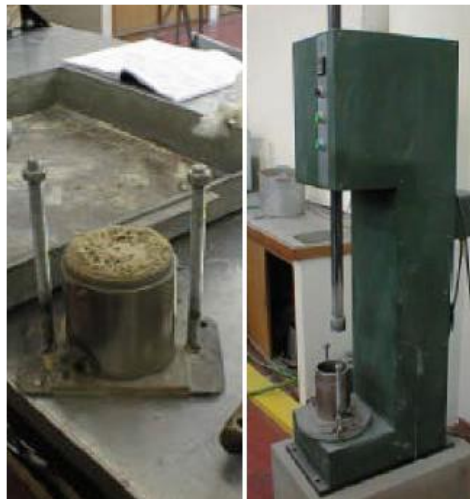
Figura 13 – Molde e equipamento de compactação do ensaio Proctor
