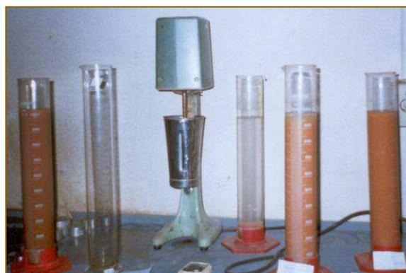
**Figura 4.10 - Ensaio de sedimentação.**
