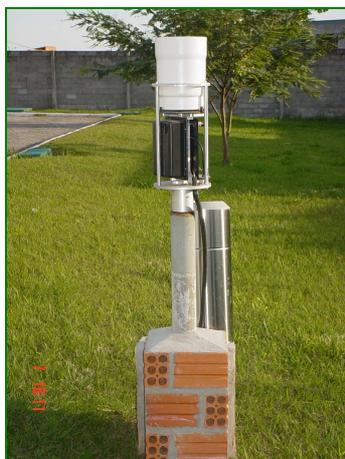
**Figura 4.2 - Pluviômetro eletrônico do tipo Pluvio OTT.**
