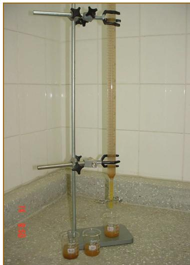
Figura 4.11 - Ensaio do Tubo de Retirada pelo Fundo.
