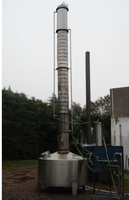
Figura 16 - Coluna de Destilação
