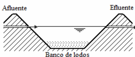
Figura 3 – Lagoa anaeróbia convencional
