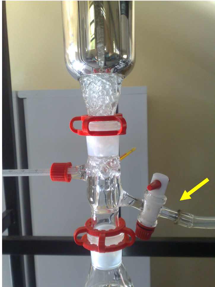
Figura 3.3 – Detalhe de um ponto de amostragem (4.b) na intersecção entre os módulos da torre de destilação.
