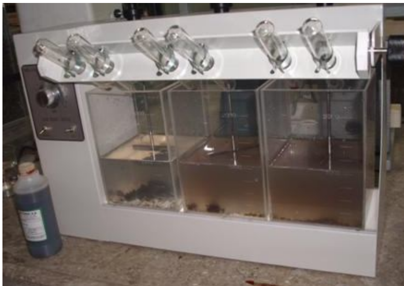
Figura 12 - Ensaio de jar test utilizando Tanfloc SL.
