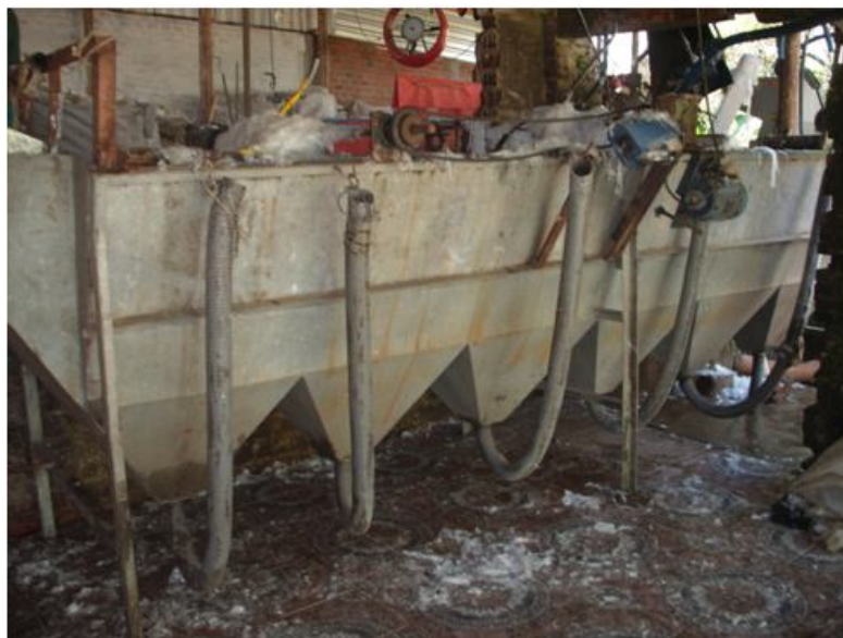
Figura 9 - Segundo tanque de lavagem do plástico picado.
