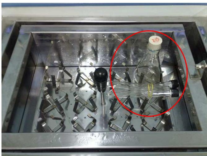
**Figura 2-1 – Banho térmico com agitação.** Em destaque, tubos de ensaio e um erlenmeyer, na posição em que eram submetidos ao banho térmico agitado.
