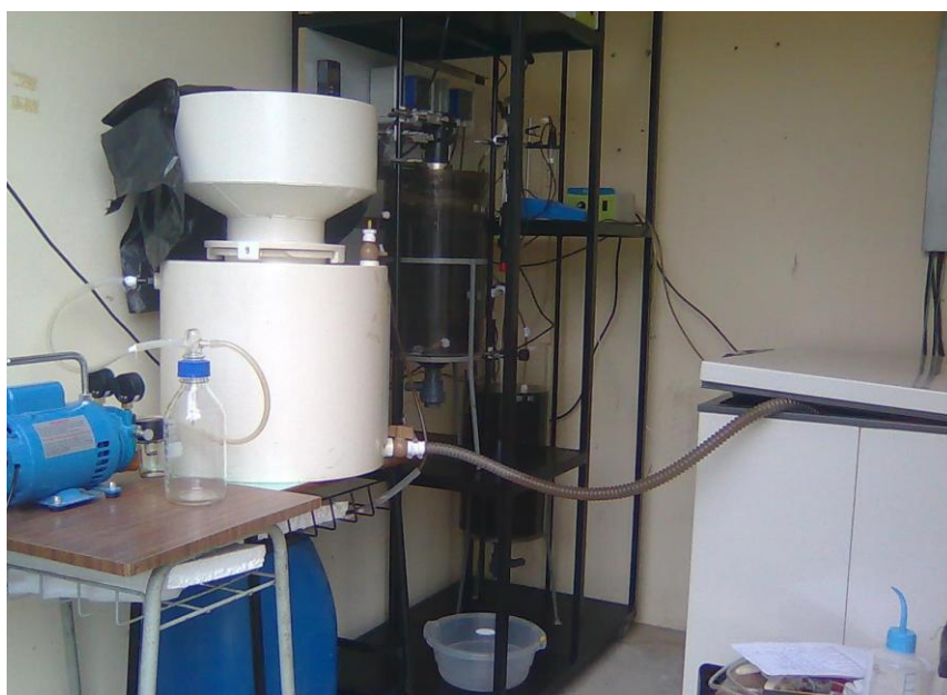
Figura 3.2 – Sistema de filtração à vácuo.
