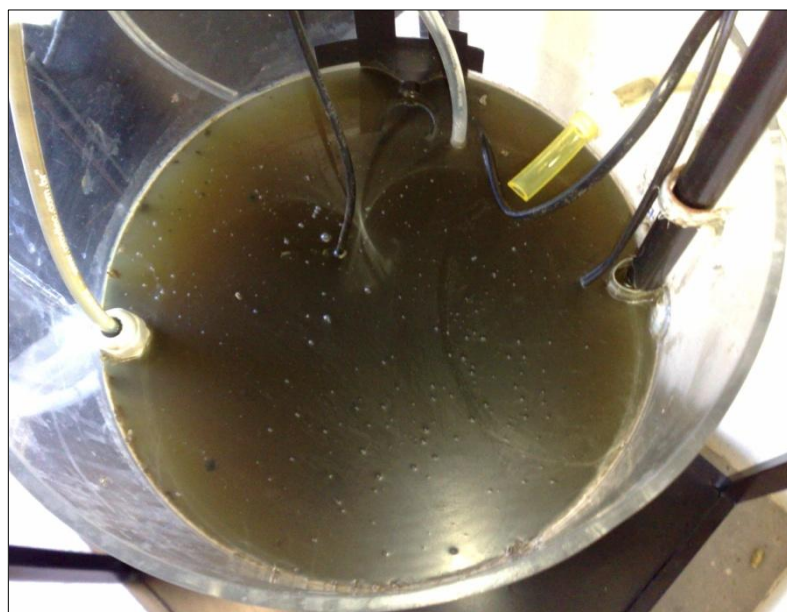
Figura 4.2 – Fotografia da superfície do reator anaeróbio em operação.
