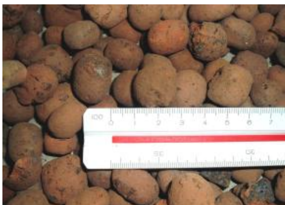
Figura 4.1 – Argila expandida com diâmetro médio de 1,5 \text{ cm} .
