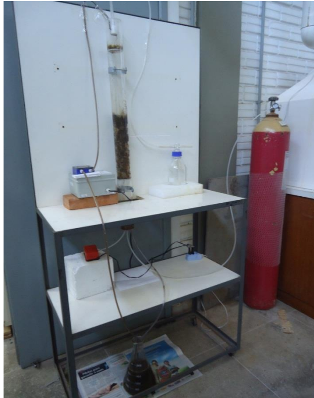
Figura 9 - Foto do sistema de biofiltração.
