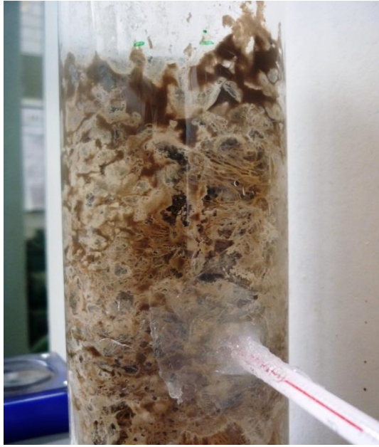
Figura 25 - Recheio filtrante no 30º dia de experimento (21-nov). (Presença de regiões esbranquiçadas)
