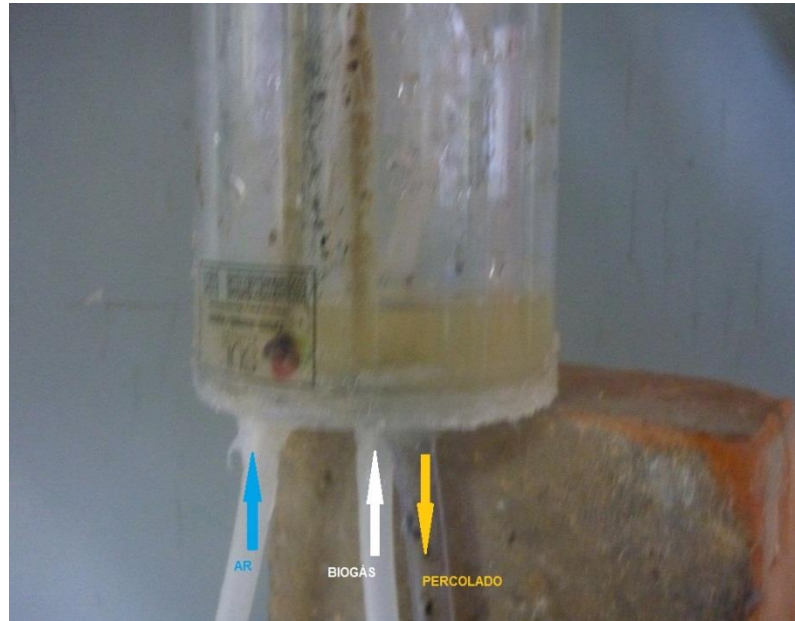
Figura 26 - Acúmulo de percolado, 2º dia (24-out).
