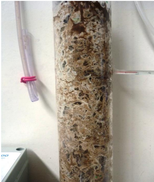
Figura 24 - Recheio filtrante no 16º dia de experimento (06-nov).(Cor marrom claro)
