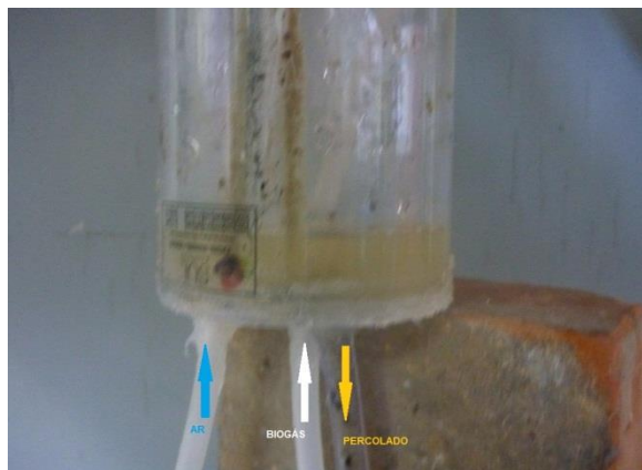
Figura 14 - Deposição de percolado um pouco antes da coleta. (A seta amarela representa o local de coleta de percolado, assim como as setas azul e branca representam os locais de entrada de ar e biogás, respectivamente).
