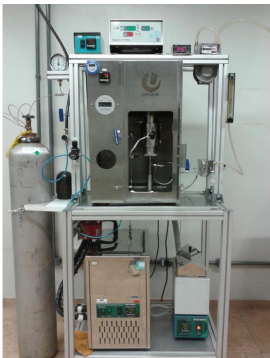
Figura 3.5 – Unidade experimental de ESC-CO 2 acoplada com US do LAPEA - UNICAMP
