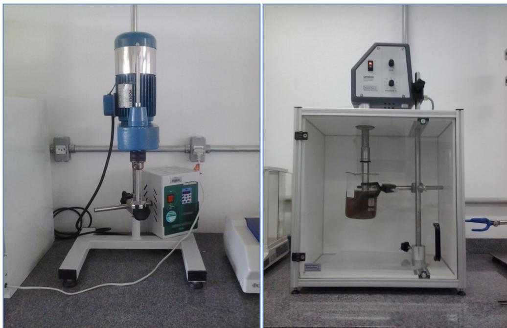
Fig 4: Agitador mecânico Turrax e agitador ultrassom, respectivamente.
