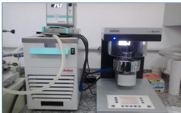
Fig 8: Tensiômetro de bancada com anel de platina (Kruss, K6).
