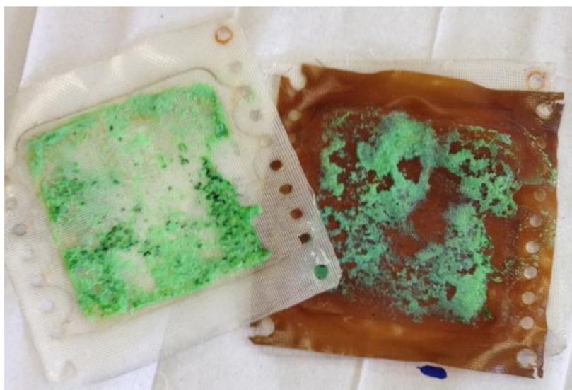
Figura 16 - Membrana de troca catiônica e telas separadas.
