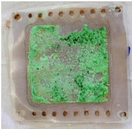
Figura 15 - Membrana de troca catiônica com a tela de proteção após os testes com as seis densidades de corrente propostas.
