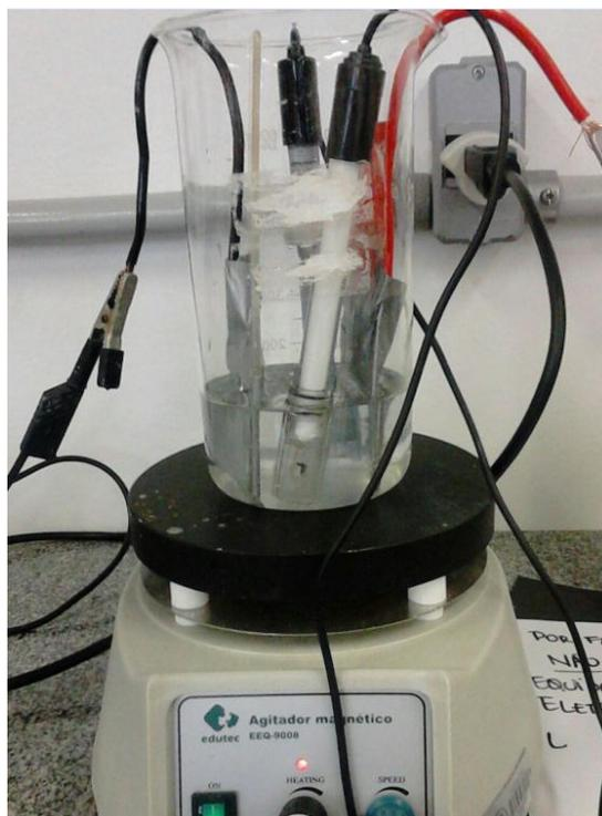
Figura 62 - Teste de eletro-obtenção realizados no béquer.
