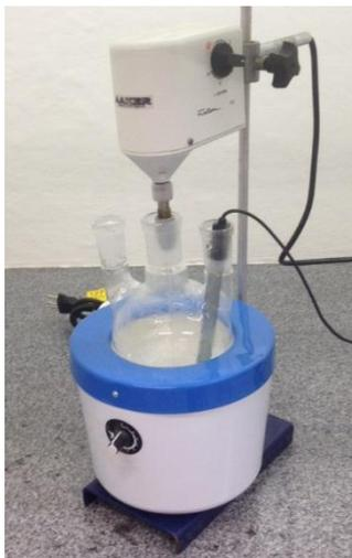
Figura 42 - Sistema montado para ensaios de extração por solventes.
