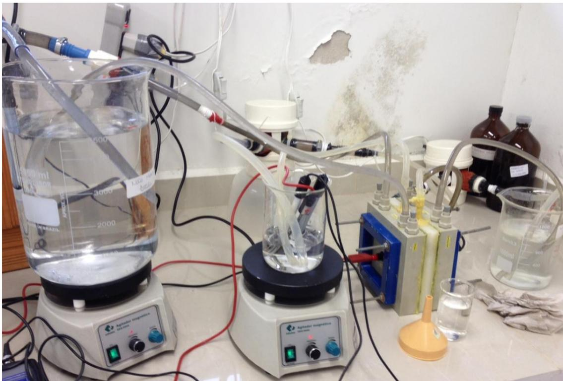
Figura 10 - Sistema de ED utilizado para aplicação da determinação de corrente ótima determinada.
