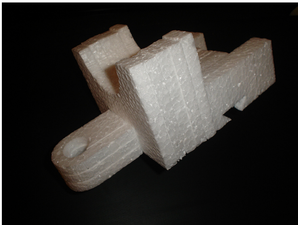
FIGURA 58 – Sólido montado usando-se o princípio de prototipagem rápida
