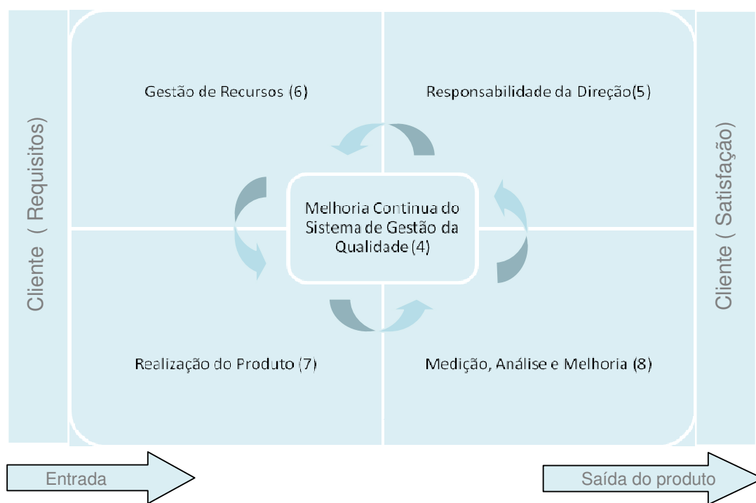
Figura 12 – Relação entre as seções da NBR ISO 9001:2008, em uma visão de processo. Fonte: Adaptado da NBR ISO 9001:2008.
