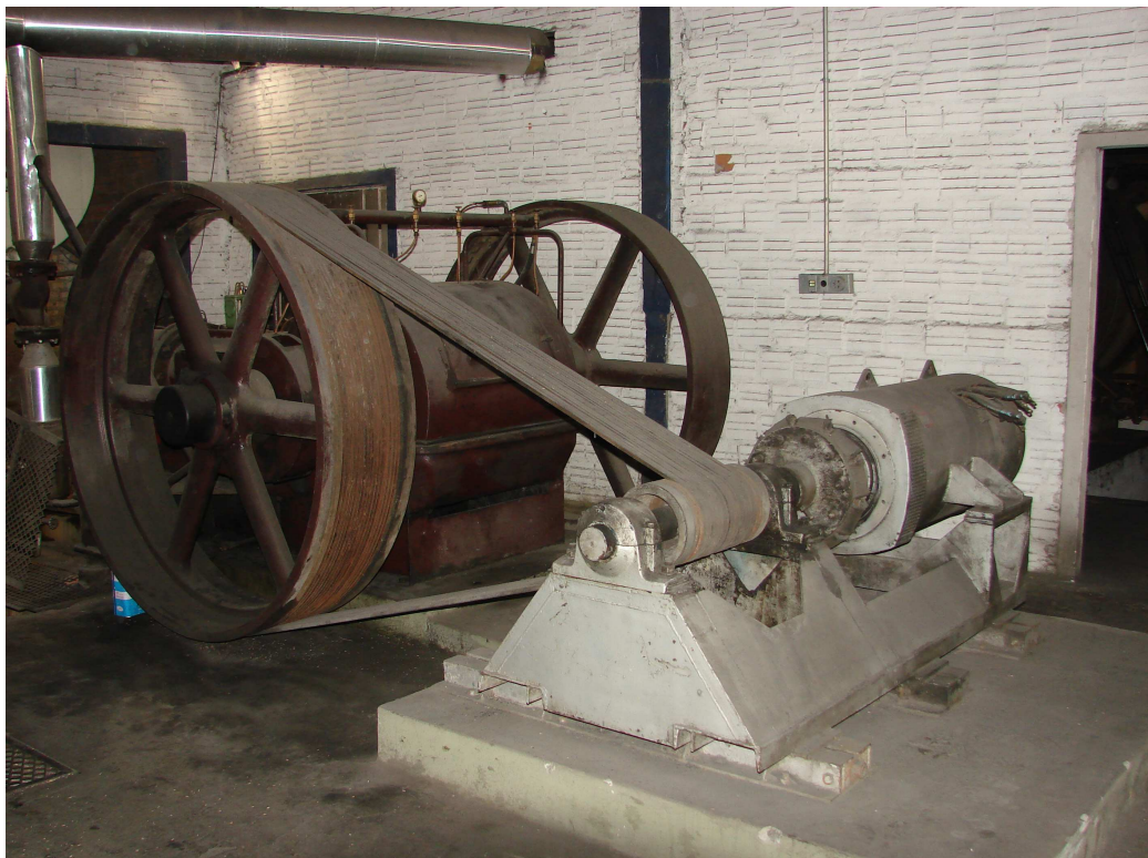
Figura 16 – Motor a vapor de pistão recíproco (locomóvel).
