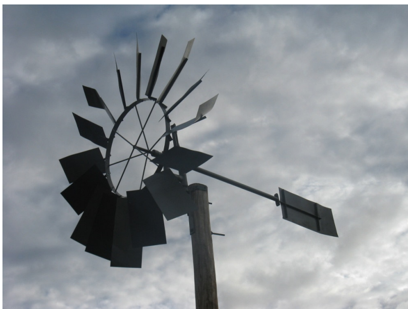
Figura 18 - Cata-vento Múltiplas pás. Fonte: Foto do autor (em funcionamento na estação 1 e na estação 2 nas localidades de Canabarro e UFMS – Santa Maria - RS.). (Fonte: Foto do autor).
