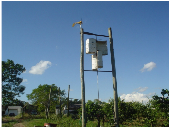
Figura 17 – Cata-vento Savonius (em funcionamento na estação 1 e na estação 2 nas localidades de Canabarro e UFSM – Santa Maria - RS.). (Fonte: Foto do autor).
