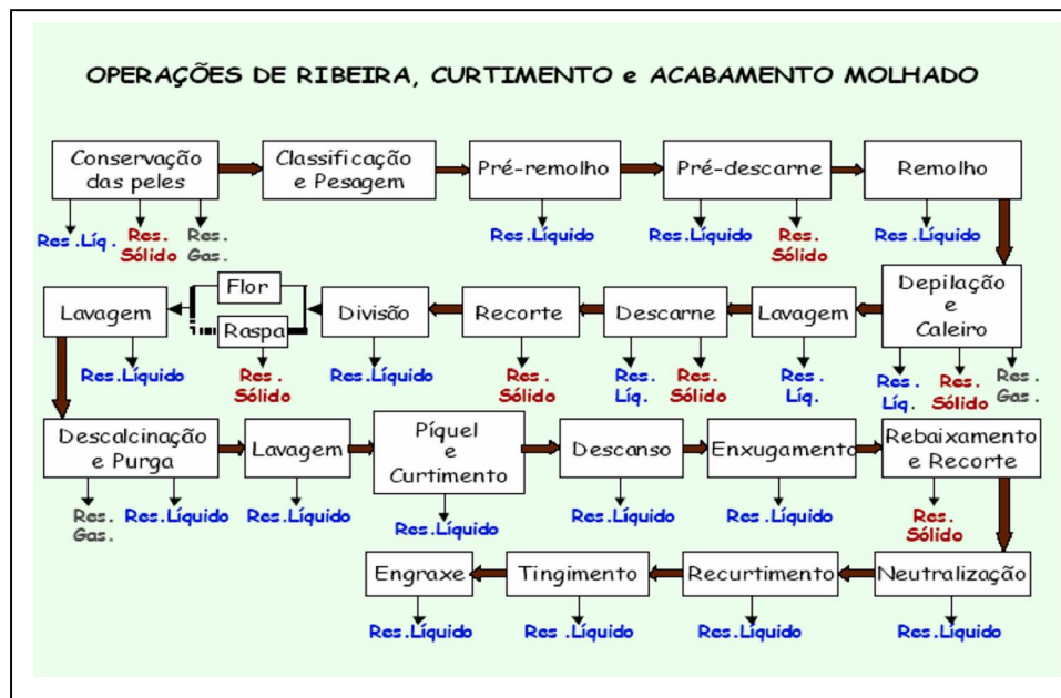
Figura 14 - Fluxograma Esquemático da Fabricação de Couros ó Operações de Ribeira, Curtimento e Acabamento Molhado
